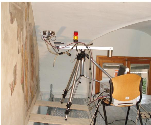
fig. 3.1 Lo strumento XRF portatile impiegato nelle indagini.
