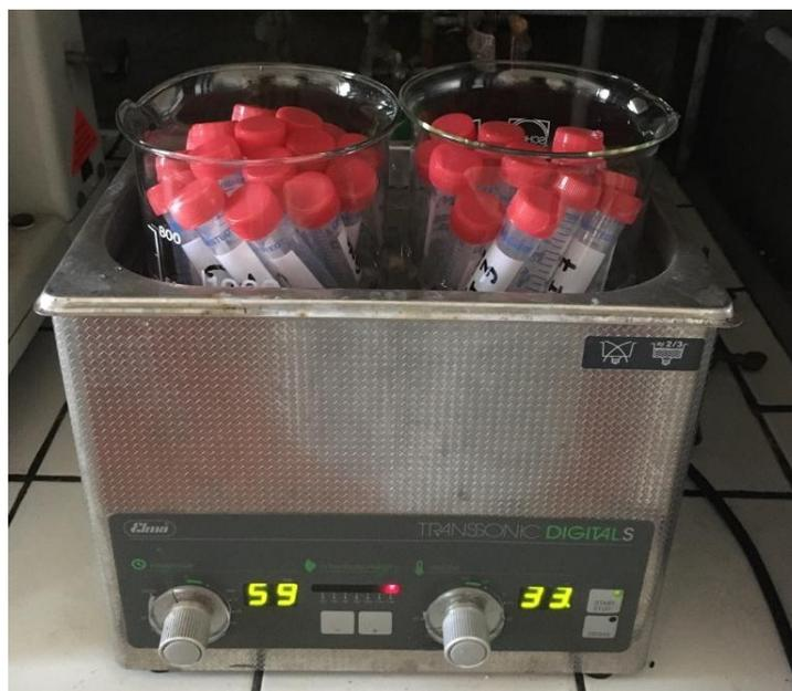
*Figura 7.4 – Riscaldamento dei campioni mediante bagno ad ultrasuoni.*
