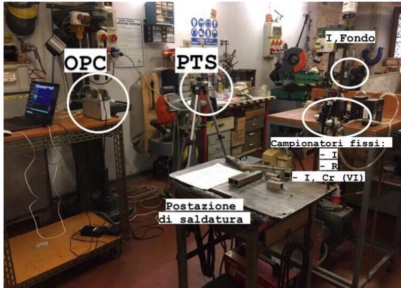
**Figura 7.6** – Posizionamento dei dispositivi fissi per il campionamento. I, inalabile; R, respirabile; PTS, polveri totali sospese; OPC, contatore ottico di particelle.
