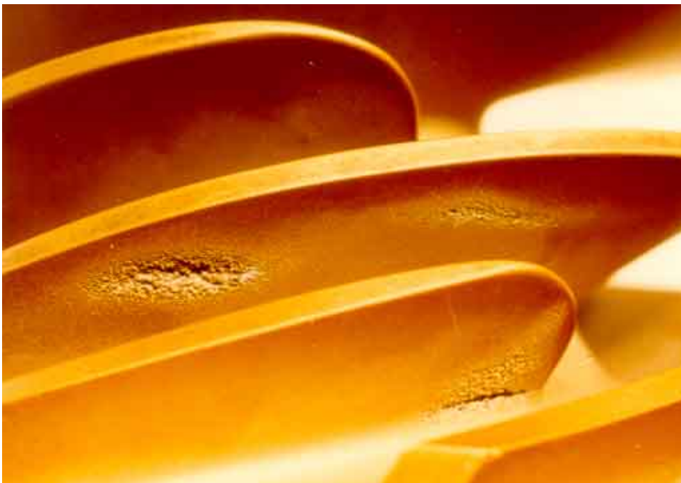
Figura 3.5 Fotografia dei danni tipici da cavitazione sulla lama di una pompa a flusso misto.
