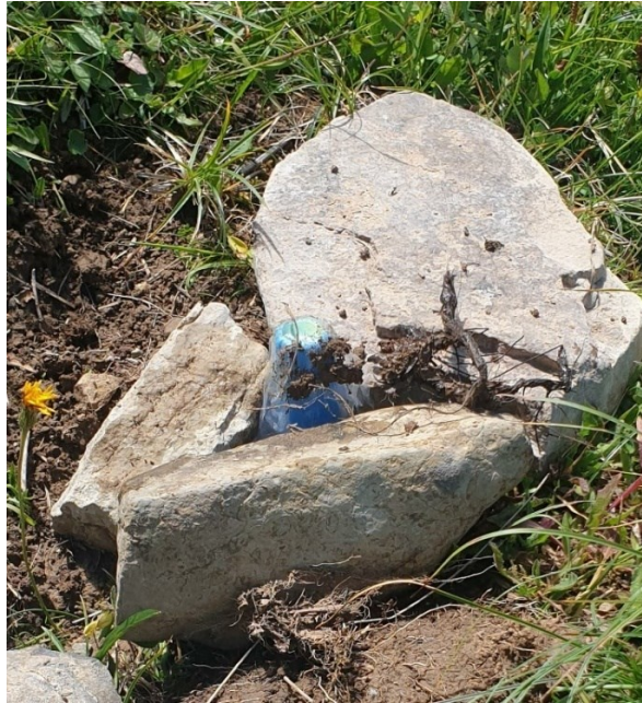
Figura 3: dettaglio della sonda ricoperta con uno strato di plastica impermeabile
