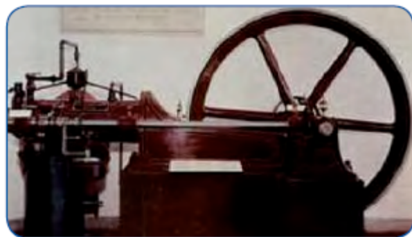
Fig. 3 Motore Otto e Langen del 1867
