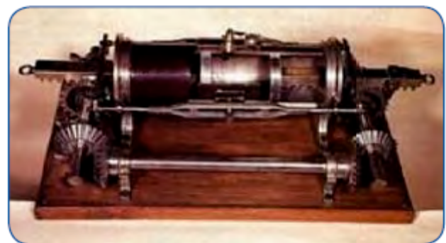
Fig. 1 Motore del 1858 di Barsanti e Matteucci a stantuffi contrapposti
