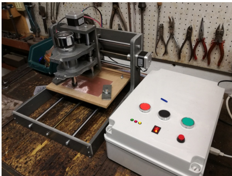
Fig. 9.4 Vista generale della fresatrice CNC e dell'elettronica di controllo
