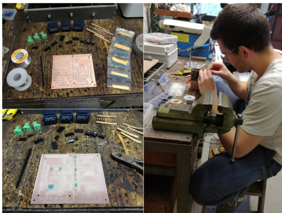
Fig. 9.7 Alcune istantanee del montaggio e saldatura dei componenti
