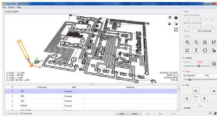
Fig. 9.3 Linterfaccia di controllo di GrblControl con il progetto di fresatura
