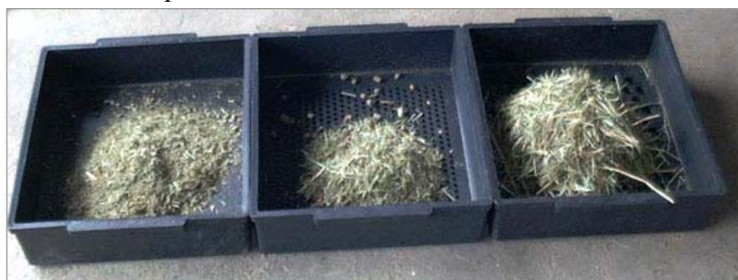
Foto 3.3 – Separatore Penn State con le diverse frazioni
