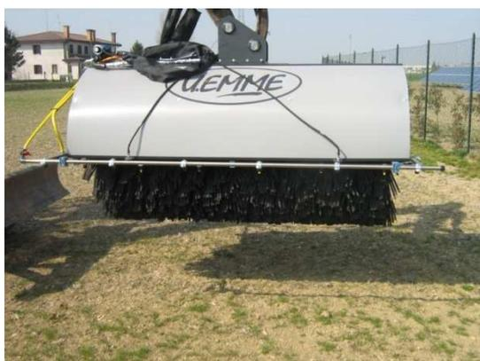
Fig.3.26-Dispositivo di pulizia moduli
