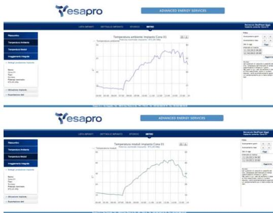
Fig.3.24- Temperatura ambiente e moduli
