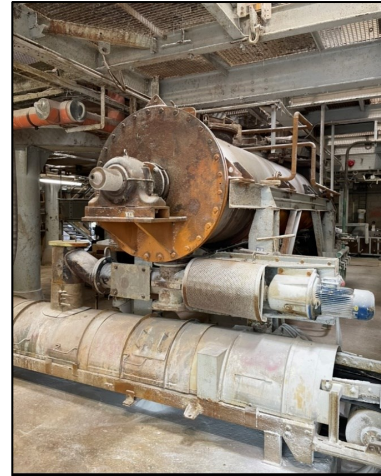
Tamburo di raffreddamento a valle del forno
