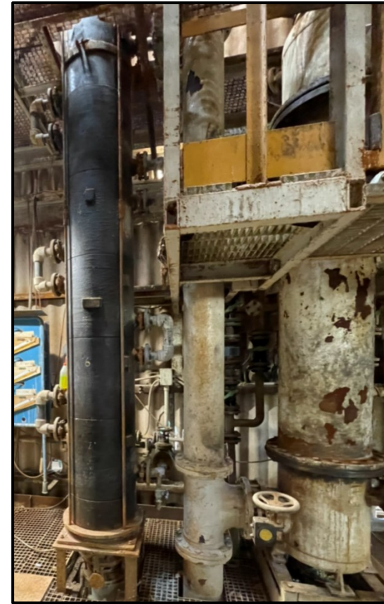
Torri di raffreddamento, assorbimento e abbattimento dei gas cloridrici prodotti all'interno della camera di reazione
