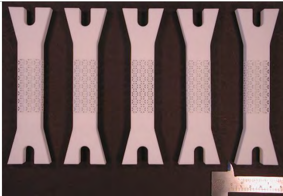
Figura 37: Provini CCCR alla densità relativa 30% (vista frontale)
