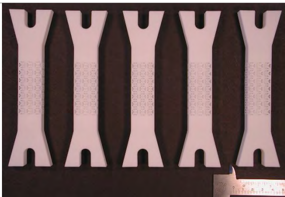
Figura 39: Provini CCCR alla densità relativa 40% (vista frontale)
