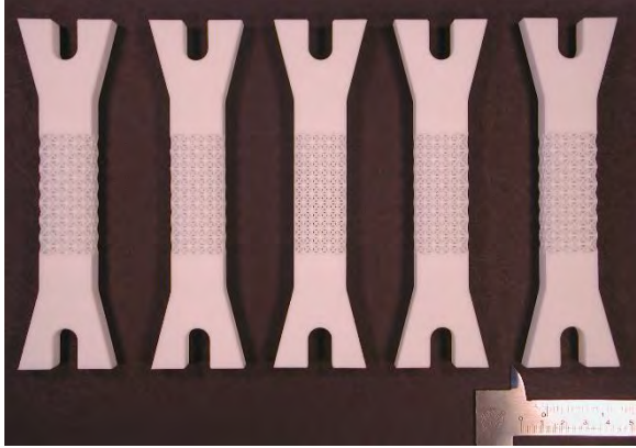
Figura 41: Provini OT alla densità relativa 20% (vista frontale)
