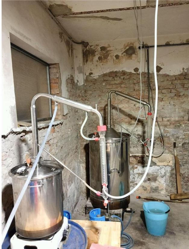
*Figura 6 - In primo piano il distillatore impiegato per l'estrazione di olio essenziale.*
