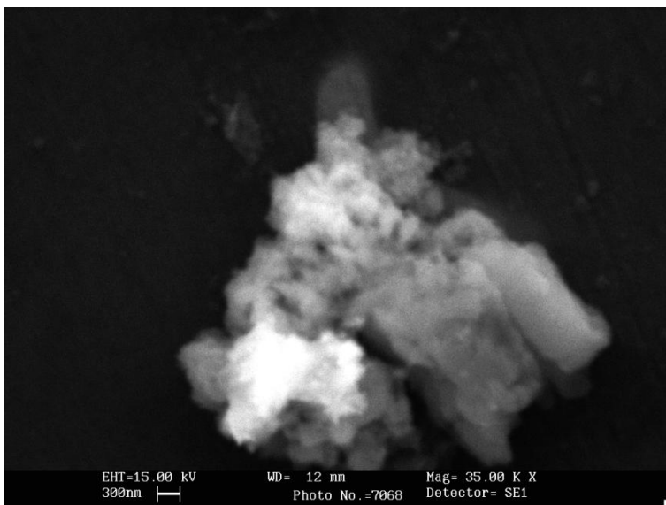
Figura 5.15: Foto SEM relativa alla lega Ferro-Cobalto
