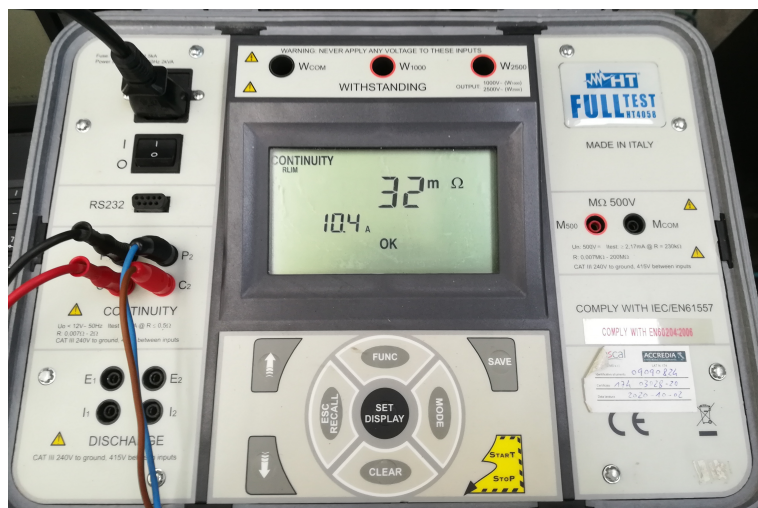
Figura 5.6: Collegamenti cavi allo strumento e display del test di continuità
