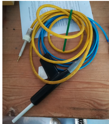
Figura 5.12: Pistola AT utilizzata in laboratorio
