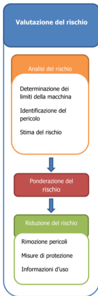
Figura A.1: Schema semplificato del procedimento da utilizzare per la valutazione del rischio
