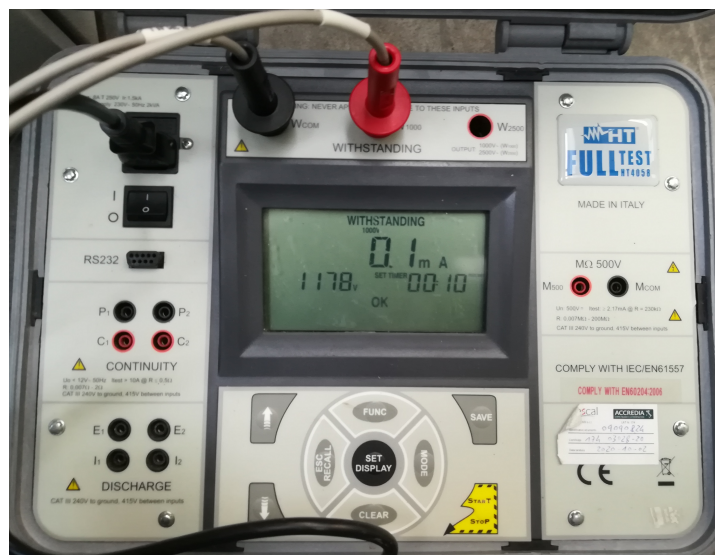
Figura 5.13: Collegamento cavi allo strumento e display della prova di tensione applicata
