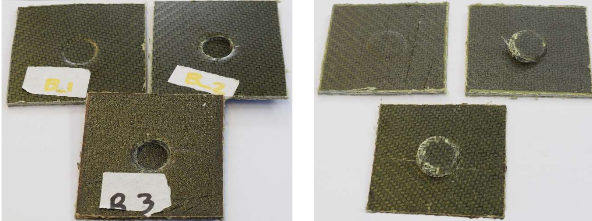
Figura 19: Superficie di applicazione dello sforzo [A] e retro [B] dei provini preparati per la prova di resistenza a taglio subito dopo la prova.
