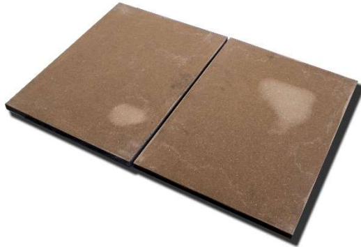
Figura 25: Stampi in MDF dei componenti parete già trattati con resina e carteggiati. Ciascuno stampo fungerà da matrice a due componenti parete che verranno poi separati per taglio.
