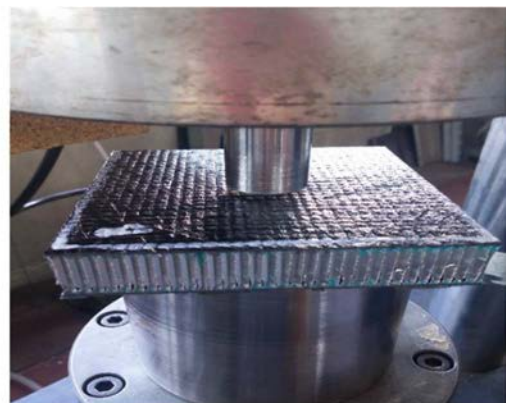
Figura 20: Grafico Forza - spostamento e allestimento di una prova di resistenza a taglio eseguita su un pannello sandwich.
