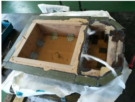
Figura 29: Visuale dello stampo del sistema Main Box + compartimento elettronica dopo la rimozione della base dello stampo.
