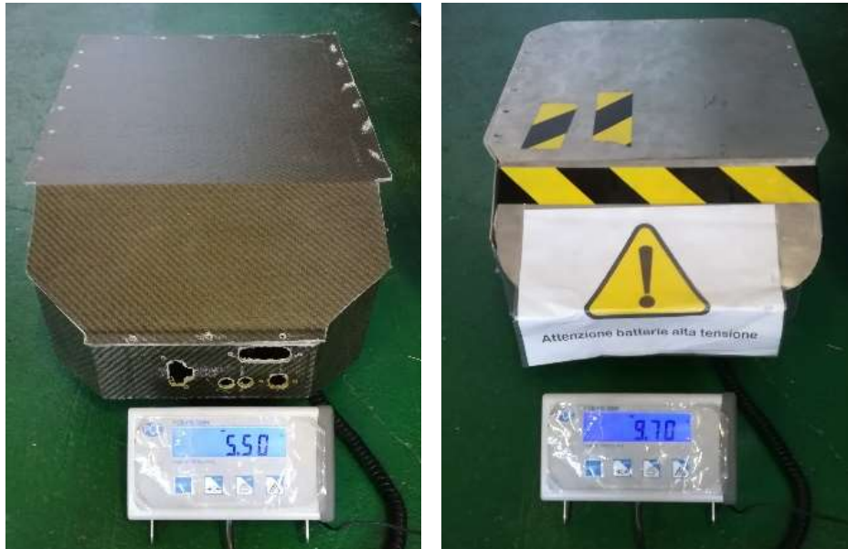
Figura 37: Pesatura delle due versioni del componente.
