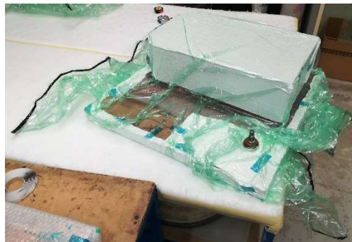
Figura 29: Il corpo principale del contenitore batterie nel sacco a vuoto.
