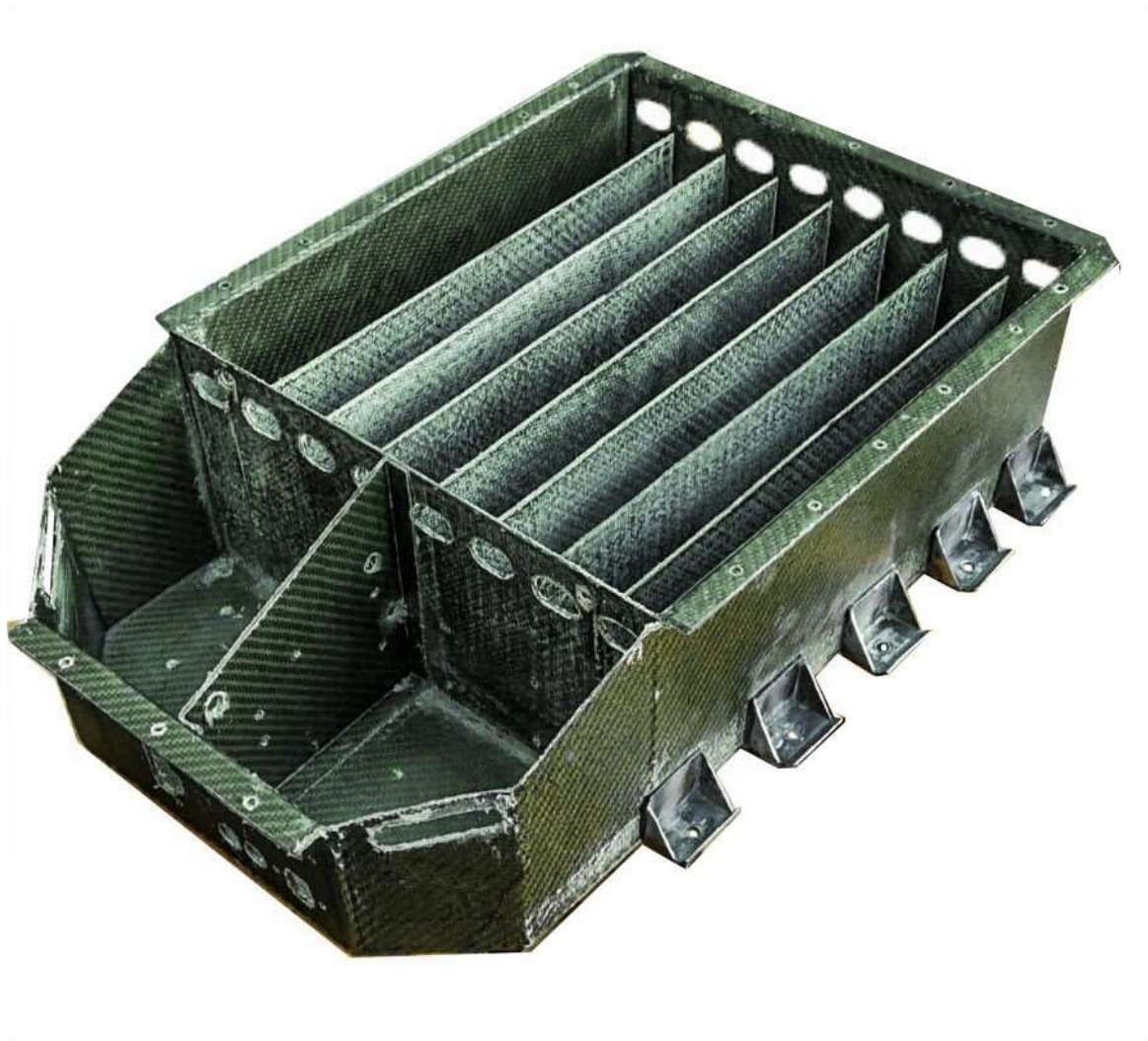
Figura 34: Il contenitore batterie ultimato e pronto per l'installazione delle celle al litio e dei componenti elettronici.
