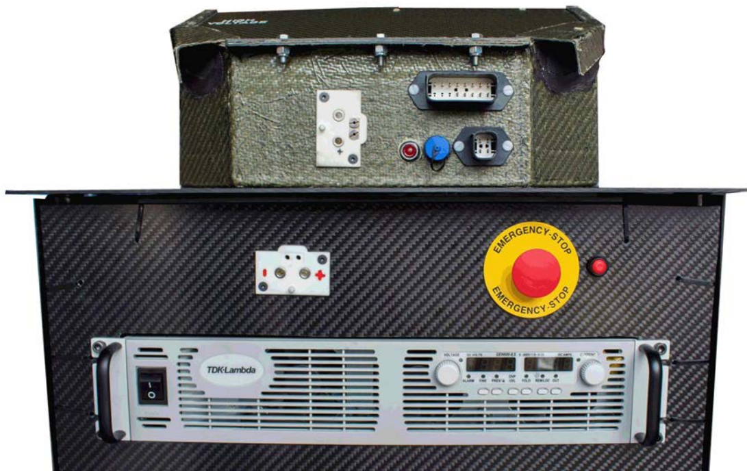
Figura 36: Vista frontale del contenitore batterie assemblato e del carrello adibito al trasporto del componente e dell'attrezzatura necessaria alla manutenzione e alla carica delle batterie.
