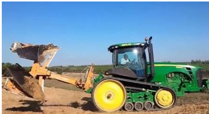
Fig. 4.20: Trattore con cingoli di gomma ed aratro da scasso
