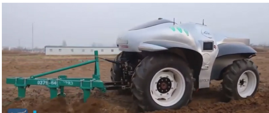
Fig. 2.12: Prototipo di trattore elettrico cinese a guida autonoma
