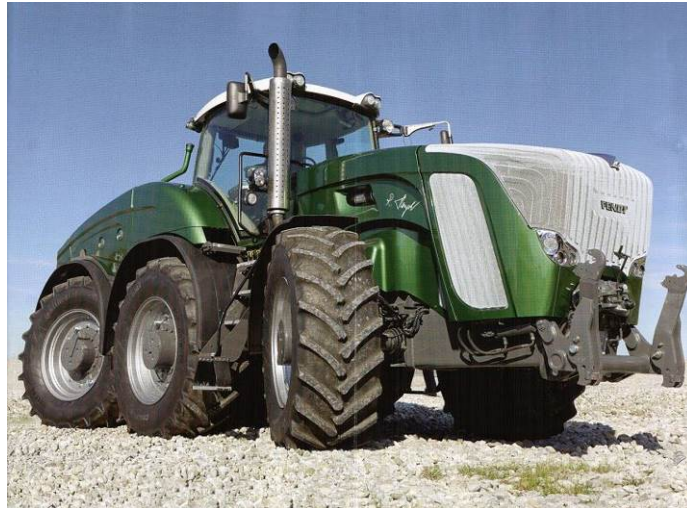
Fig. 4.12: Trattore Fendt (Trisix Vario) con sei ruote motrici, delle quali quattro sterzanti (due all'avantreno e due al retrotreno)
