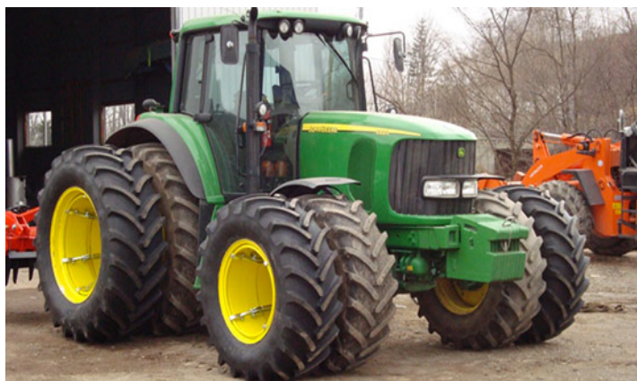
Fig. 4.11: Trattore John Deere con otto ruote gemellate
