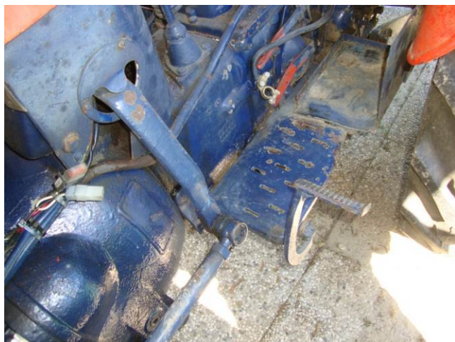
Fig. 5.13: Trattore Same degli anni '60 - esempio della scomoda posizione del pedale della frizione, collocato tutto a sinistra in modo da evitare l'interferenza con il rinvio del comando dello sterzo
