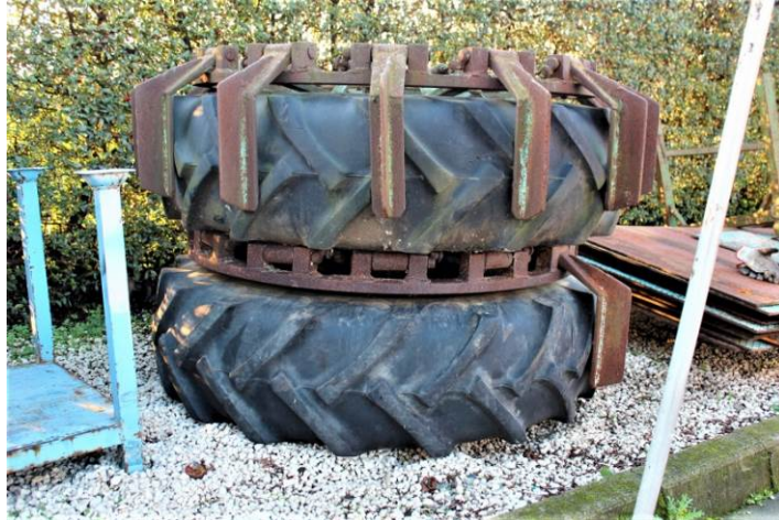
Fig. 4.6: Ruota gommata accoppiata a gabbia ribaltata
