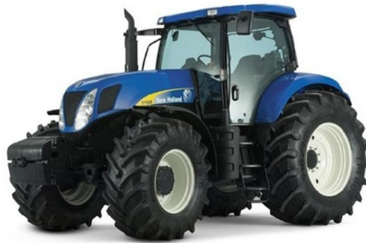
Fig. 4.2: Trattore con 4 ruote motrici
