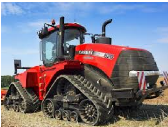
Fig. 4.18: Trattore Case con doppi cingoli di gomma
