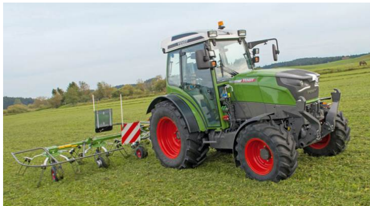
Fig. 2.5: Trattore elettrico Fendt e 100 Vario
