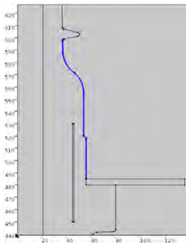
Fig. 5.32 valutazione della sollecitazione elettrica: a) alettatura superiore, b) alettatura inferiore
