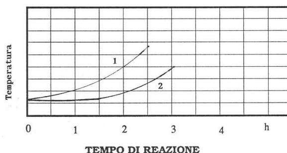
Fig. 3.12 reazione esotermica di due differenti tipi di mescola
