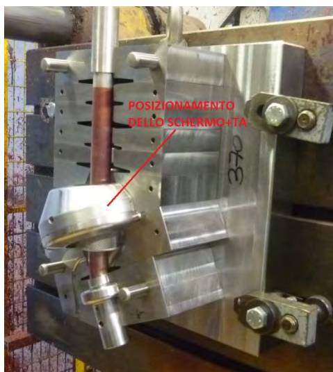
Fig. 5.77 criticità nel posizionamento dello schermo+TA all'interno dello stampo
