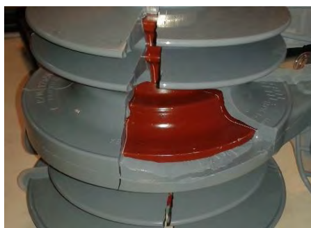
Fig. 4.2 esempio di isolatore composito con nucleo in resina epossidica e guscio in gomma siliconica
