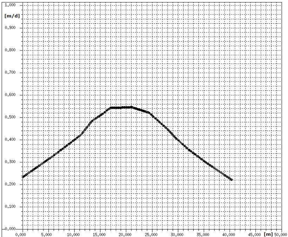
Grafico 11: Sezione tracciata perpendicolarmente alla direzione congiungente i pozzi PE e PR (Grafico 10) ed equidistante dai due. Raffigura l'andamento delle velocità (in ordinata) espressa in [m/d]
