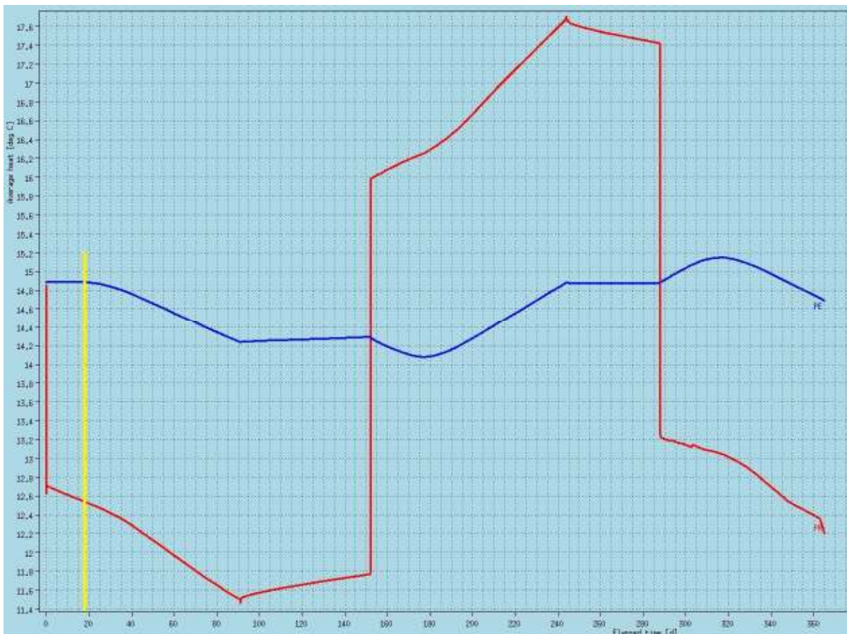
Grafico 8: Curve di temperatura media espressa in gradi Celsius [°C] per PE (in blu) e PR (in rosso); in ordinata troviamo il tempo espresso in giorni [d]. La linea gialla individua il momento in cui comincia a manifestarsi il fenomeno della corto-circuitazione termica.
