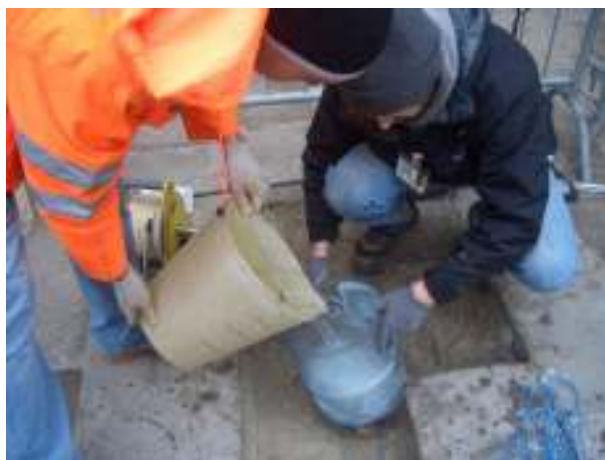
Figura 48: Esecuzione dello slug test
