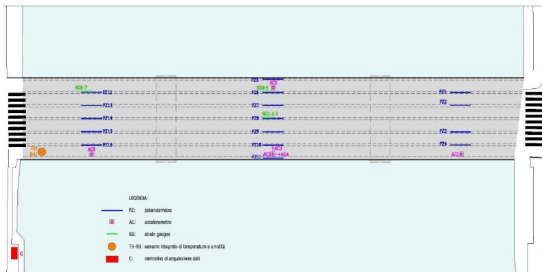
Fig. 54 – Posizionamento dei sensori in pianta.
