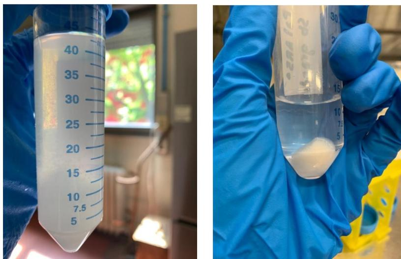
**Figura 17:** *Precipitazione del peptide in etere dietilico (a sinistra); fotografia della stessa provetta dopo la centrifugazione (a destra)*
