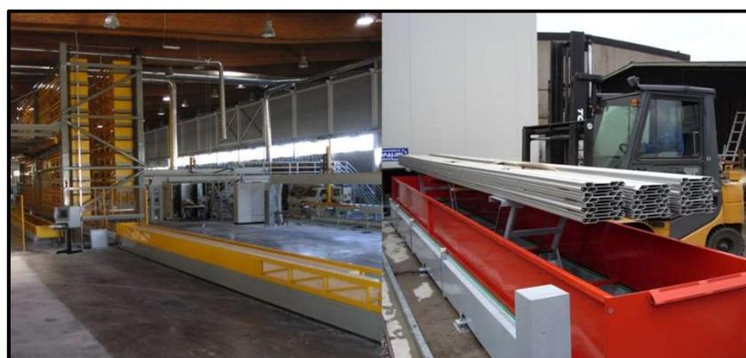
Figura 95: Caricamento laterale BI.MAG. (fonte: <http://www.ciampalini.it/bimag-sistema-stoccaggio-barre/>)
