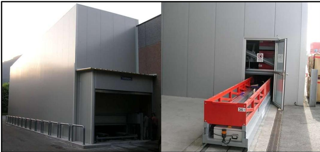
Figura 97: Magazzino BIMAG installato esternamente al capannone con carico esterno. (fonte: <http://www.ciampalini.it/bimag-sistema-stoccaggio-barre/>)
