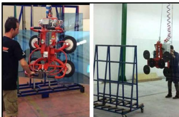
Figura 83: Esempio servo manipolatore vetri ELEPHANT. (fonte: <https://www.elephant.it/prodotto/vt2rb/>)
