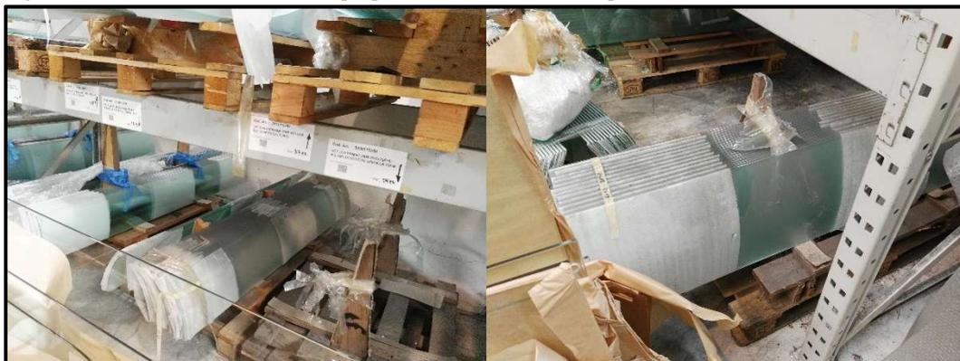
*Figura 61: Esempio prelievo materiale indisciplinato, spreco di spazio libero.*
