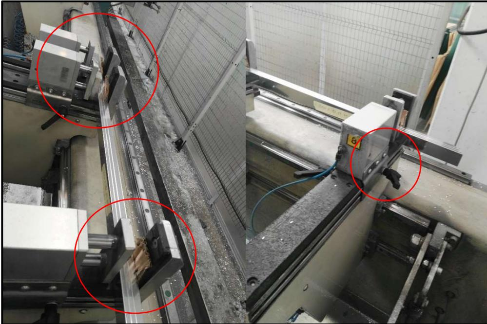
*Figura 71: Blocchi pneumatici del centro di lavoro in evidente stato di usura.*
