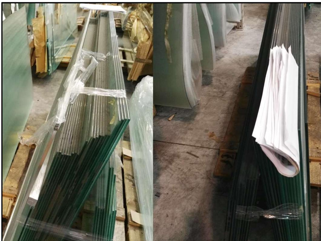
*Figura 60: Vetri stoccati in un'area impropria con evidente strato di polvere.*
