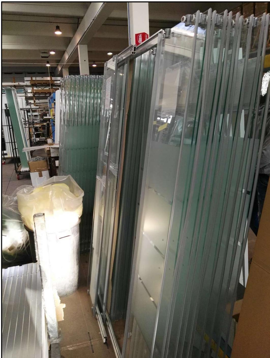
*Figura 50: Buffer pezzi montati in attesa di essere imballati.*
