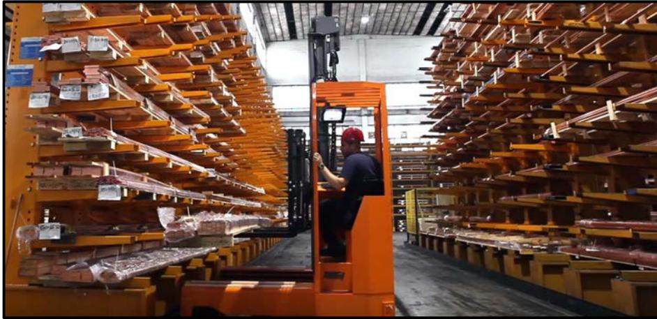
Figura 78: Esempio carrello elevatore multidirezionale. (fonte: <https://www.omgindustry.com/it/>)
