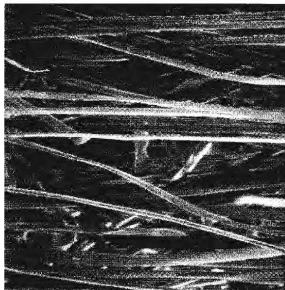
Fig. 7.33. Filamenti di un geotessuto non tessuto agugliato e calandrato orientati parallelamente alla direzione del taglio dopo 1000 mm di spostamento in un Apparecchio Anulare di Taglio Diretto. (Stark et al._1996)
