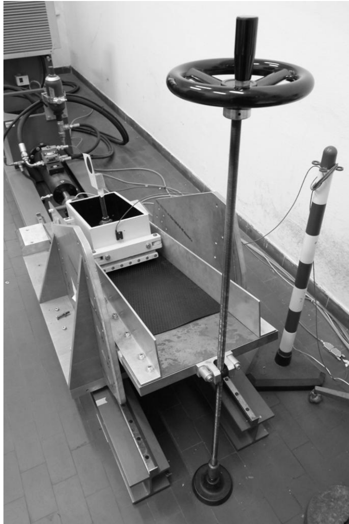
Fig. 9.5. Particolare del sistema di inclinazione del piano ad avvitamento manuale del dispositivo sperimentale dell'Università di Padova (ICEA).
