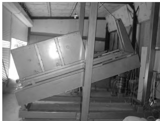
Fig. 7.5. Foto del piano inclinato per lo svolgimento di test sotto condizioni bagnate. (L. Briançon et al._2002)
