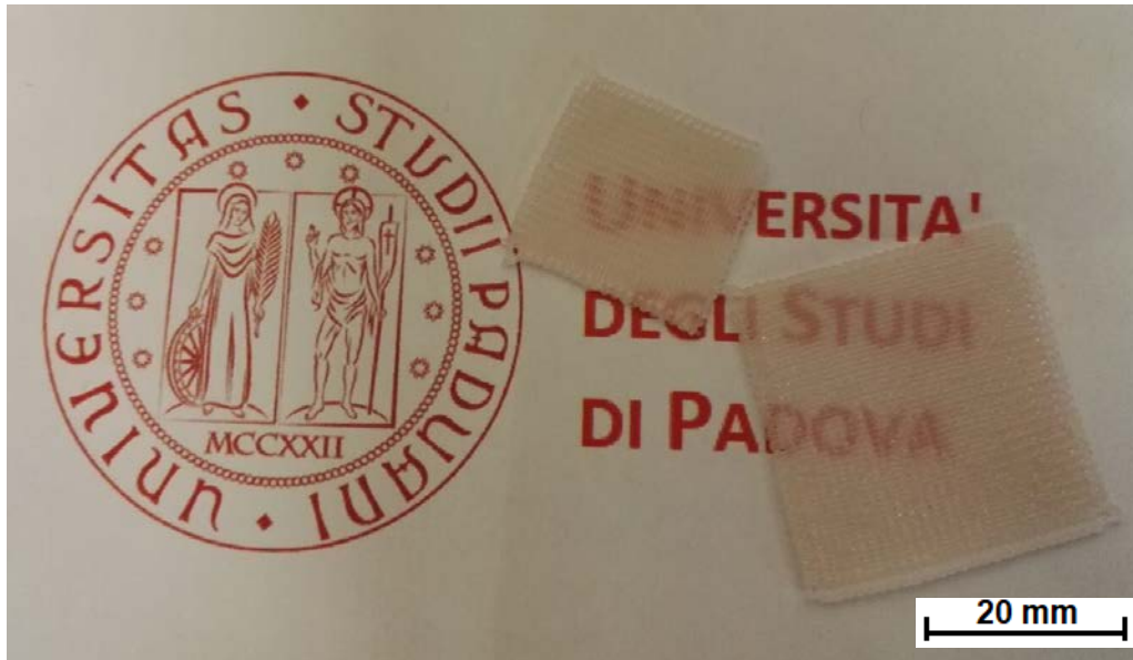
Figura 3.12: scaffold sinterizzati a 950 °C per 1.5 h (ugello 0.016”).
