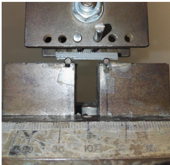
Figura 2.4: configurazione per la prova di flessione a 4 punti.
