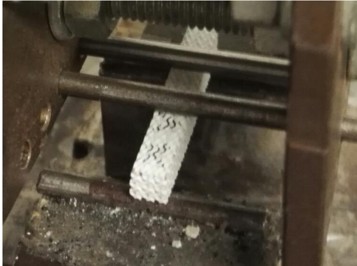
Figura 3.34: prova di resistenza a flessione a 4 punti per scaffold di WDE.
