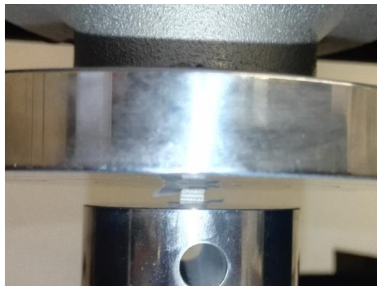
Figura 3.22: prova di compressione sui provini di vetro NEG.
