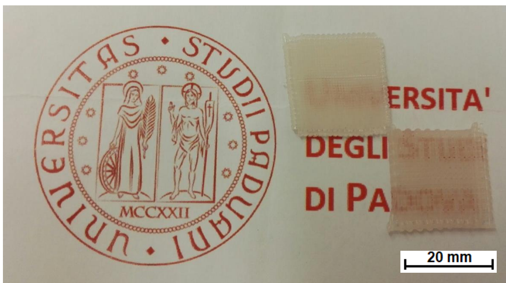
Figura 3.11: scaffold sinterizzati a 925 °C per 1.5 h (ugello 0.016” in alto, ugello da 0.033” in basso).
