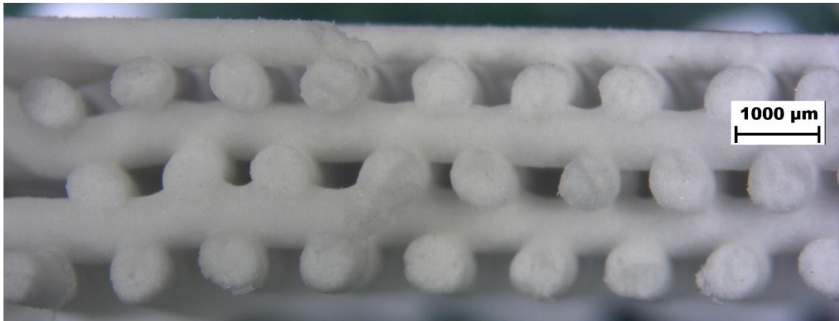
Figura 3.5: vista in sezione del verde (ugello da 0.033") ottenuta con microscopio ottico.
