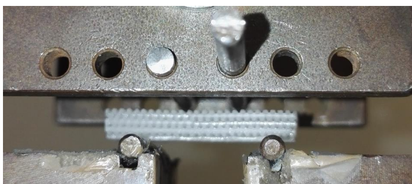
Figura 3.21: prova di flessione a 4 punti su un componente in vetro NEG.
