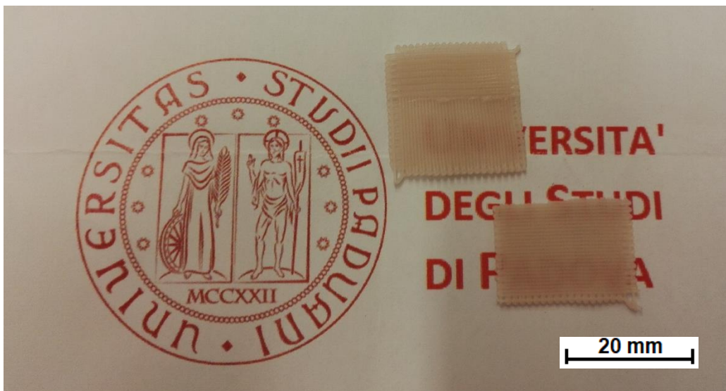
Figura 3.10: scaffold sinterizzati a 900 °C per 1.5 h (ugello 0.016”).
