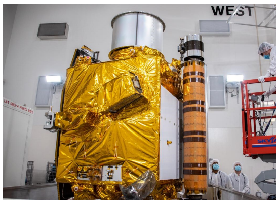
Figura 3.2: La sonda DART appena installata sul payload adapter. Al centro è possibile vedere il dispenser di LICIACube. (NASA/JHU-APL)
