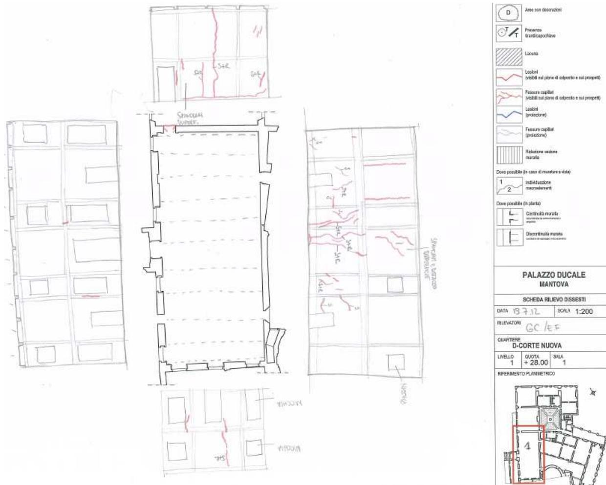
Figura 2.8: rilievo fessurazioni piano 1 sala di Manto
