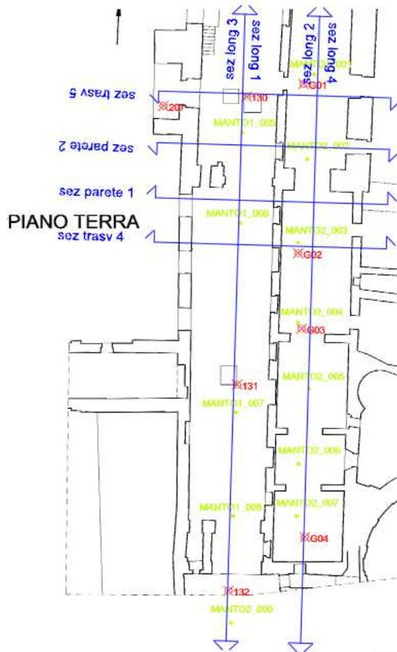
Figura 2.4: schema sezioni prodotte dal rilievo con Laser scanner
