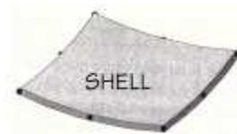
Gli shell sono elementi a 3 gradi di libertà traslazionali + 3 g.d.l. rotazionali = 6 g.d.l., utili per modellare strutture in parete sottile con larga estensione in confronto ad un ridotto spessore, che presentino sforzi nella direzione dello spessore trascurabili. Tali elementi possono avere formulazione thin e thick, cioè effetto del taglio trasversale trascurato o incluso ed essere a 3,4,6,8 nodi.
