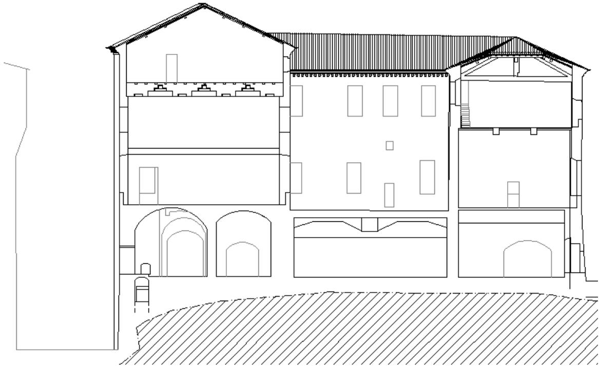
Come espresso precedentemente altra competenza del rilievo geometrico è identificare quali siano le imposte degli orizzontamenti e dei sistemi archivoltati, per cui si riportano (tramite l'ausilio schematico del modello) le pareti di ogni piano su cui insistono gli orizzontamenti.
