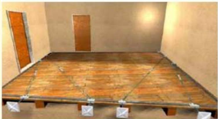
Figura 6.34 – Tiranti metallici a livello solai lignei
