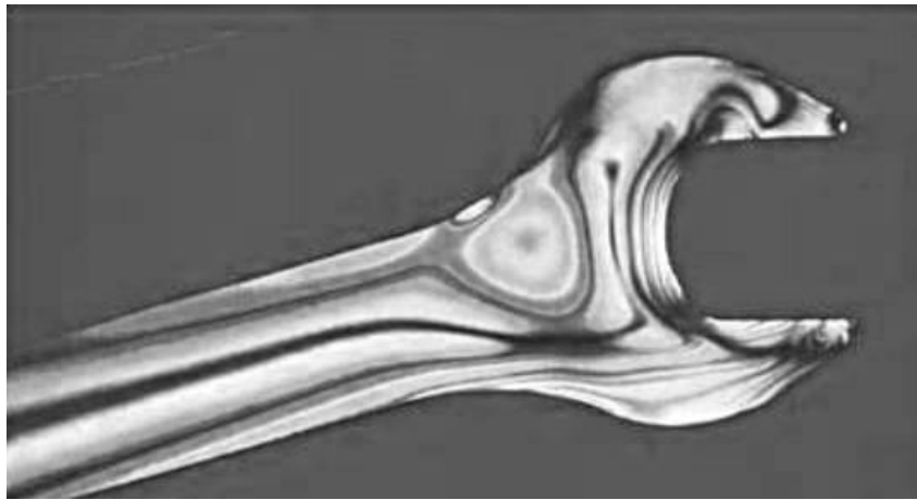
Figura 1: Esempio di applicazione di fotoelasticità su un oggetto
