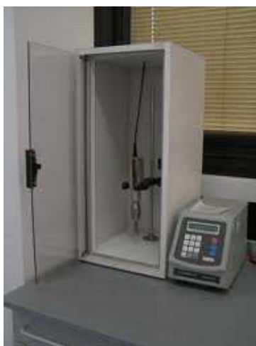
Figura 3.5 VC505 ® prodotto dalla Sonics Vibra-Cell
