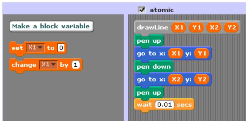
Il blocco drawLine è il blocco “cappello”, quindi viene preso lo strumento penna, ci si posiziona sul punto di inizio x1,y1, si appoggia la penna al “foglio” e ci si sposta verso il punto di fine con coordinate x2,y2. Quindi si riprende la penna. Con il blocco “wait”, si riesce a vedere l’operazione mentre viene eseguita, altrimenti si vedrebbe solamente il risultato finale.
