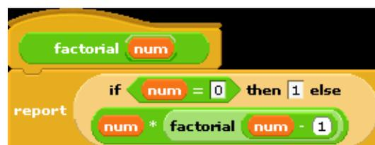
Il problema è che in Scratch, quando un blocco viene chiamato, tutti i suoi ingressi sono valutati prima che lo script del blocco venga lanciato. Lo stesso blocco, inoltre, conosce solo i valori dei suoi ingressi, non le espressioni che sono state utilizzate per calcolarli. Questo significa che il fattoriale richiama se stesso ricorsivamente, e causa un loop infinito. Dobbiamo costruire un blocco “if else” in grado di selezionare una delle due alternative che devono essere eseguite.
