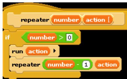
La parentesi quadra vicino ad action indica che questo è un blocco di tipo Command e che lo script racchiuso nella forma C è l'azione di input dello script. Per dichiarare una procedura di input, aprire la dialog di creazione input e cliccare sulla freccia per espandere la finestra e visualizzare tutte le opzioni a disposizione, e quindi scegliere il tipo di procedura:
