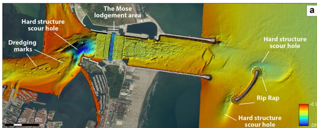
Figura 18: Esempio di restituzione ombreggiata a colori di batimetria ad alta risoluzione (0.2 m). Fondale del Porto di Chioggia sono evidenti segni di dragaggio, rip-rap, zone di alloggiamento del MOSE e solchi nel fondale in corrispondenza delle estremità dei frangi acque.
