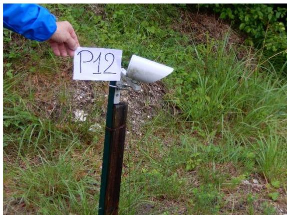
*Figura 113 Foto dello scrivente per l'attività di catasto delle mire ottiche della stazione topografica totale robotizzata di Perarolo, datata 24/05/2018.*
