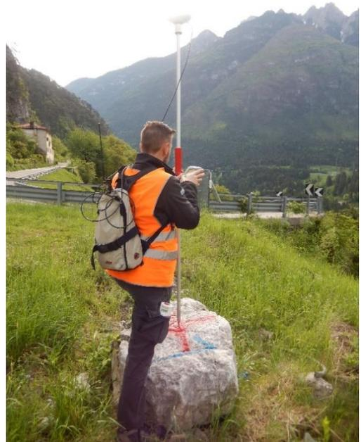
*Figura 152 A sinistra stazione GPS MASTER RTK sulla frana di Sant'Andrea in occasione del rilievo fotogrammetrico con drone del 10/05/2018. Nel cerchio rosso la posizione della stazione GPS statica dietro il municipio di Perarolo. A destra rilevamento della posizione di un 'ground control point' con il ROVER. Foto dello scrivente.*
