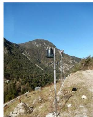
Figura 163 Stazione pluviometrica sul corpo della frana di Sant'Andrea. Foto dello scrivente del 06/04/2018.
