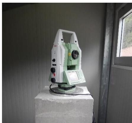
Figura 110 Stazione topografica totale robotizzata attiva a Perarolo (modello TM30, prodotto da *Leica Geosystems AG*). Foto dello scrivente 29/05/2018.
