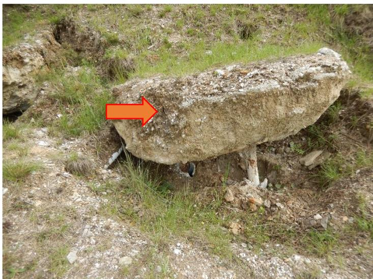
*Figura 32 Esempio di bulbo di influenza generato nel terreno dalla realizzazione dei pali, in particolare modo attraverso l'iniezione di miscela cementizia. Foto dello scrivente del 10/05/2018.*
