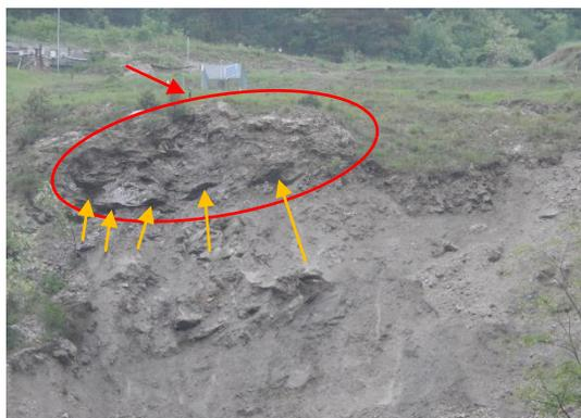
*Figura 131 Mira P15 (freccia rossa) sul blocco di materiale svincolato dal resto del versante (ellisse rossa) alla base del quale si rinvergono le cavità (freccie arancio) da cui si nota fuoriuscita d'acqua nel corso degli eventi meteorologici più intensi (già richiamate nei capitoli precedenti). Foto dello scrivente del 24/05/2018.*
