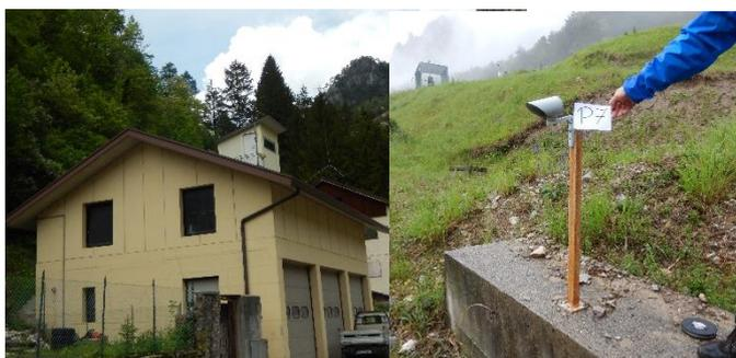
Figura 45 A sinistra base della stazione topografica totale robotizzata che monitora la frana di Sant'Andrea. Essa è posizionata sul tetto della caserma dei Vigili del Fuoco di Perarolo di Cadore (BL). Foto dello scrivente del 10/05/2018. A destra esempio di mira ottica.
