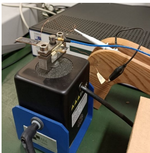
Fig. 4.12 - Campione fissato sullo shaker elettrodinamico, connessione della sonda passiva di tensione ai morsetti del campione e accelerometro piezoelettrico.
