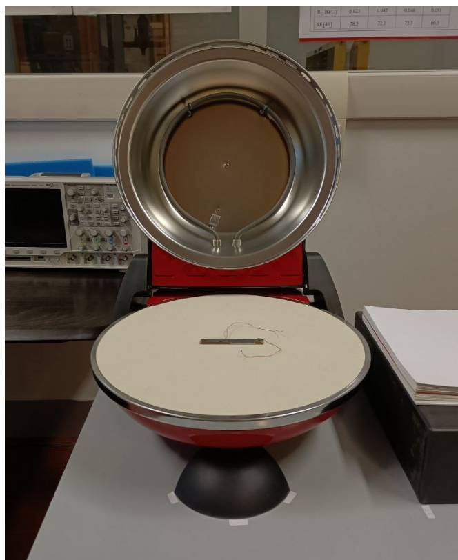
Fig. 5.14 - Disposizione del campione sul piatto d'appoggio del forno.
