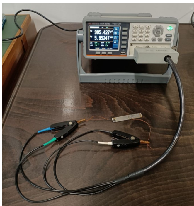
Fig. 5.9 - Setup di misura con misuratore digitale LCR.
