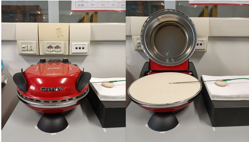
Fig. 5.1 - Posizionamento del sensore di temperatura all'interno del forno per le prove di caratterizzazione preliminari. La sonda è fatta passare attraverso le aperture del forno, posizionata centralmente, a contatto con il piatto d'appoggio (in pietra refrattaria).
