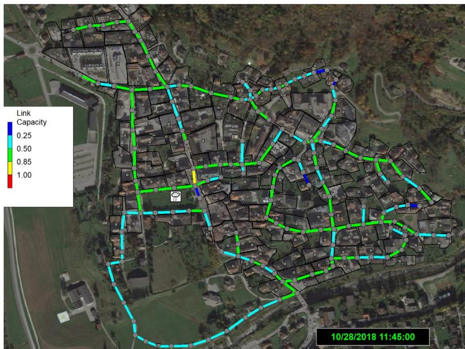
Figura 4.14: del sistema all'interno del software SWMM durante una simulazione della tempesta Vaia, per la precisione il 28 ottobre alle ore 11:45. Le condotte assumono colorazioni differenti a seconda del grado di riempimento in quell'istante.
