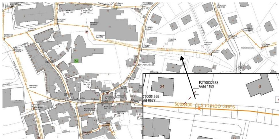
Figura 3.2: in basso a destra un ingrandimento per far notare la presenza di condotte in sezione rettangolare con fondo in grès.
