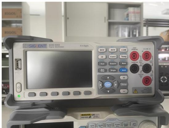
Figura 1: Multimetro da laboratorio digitale
