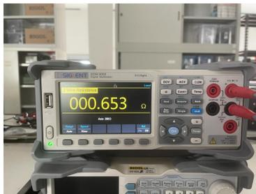
Figura 7: Risultato della misurazione di  $R_a$  con il metodo a 2 terminali
