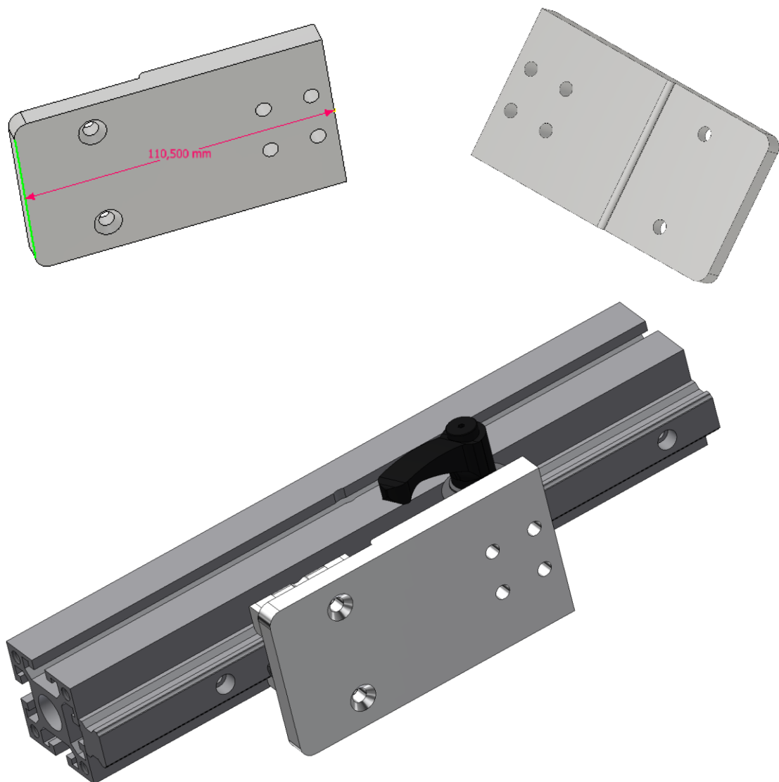
Figure 5.3: Creazione della piastra di fissaggio per i due pattini di scorrimento lineare
