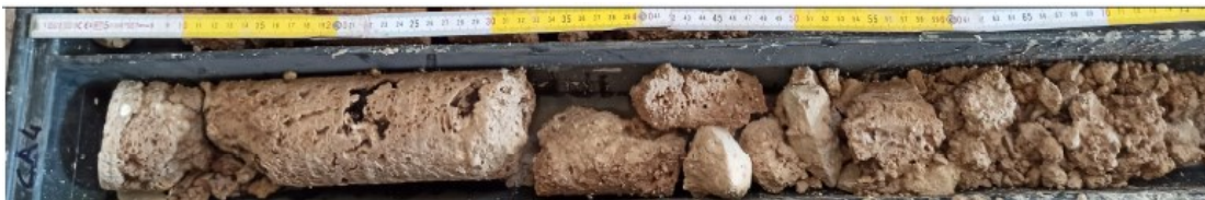
Figura 5.25 - Carota quarto test, paramento interno, lato est, primo livello. Lunghezza carota 78 cm.
