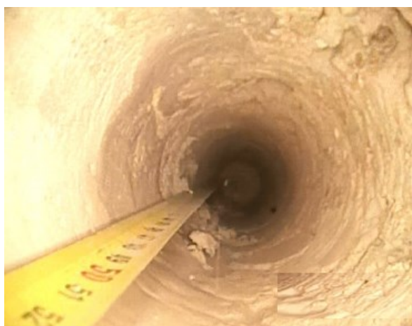
Figura 5.22 - Endoscopia svolta all'interno del terzo carotaggio
