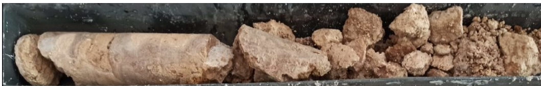
Figura 5.21 - Carota primo test, paramento interno primo livello. Lunghezza carota 72 cm.
