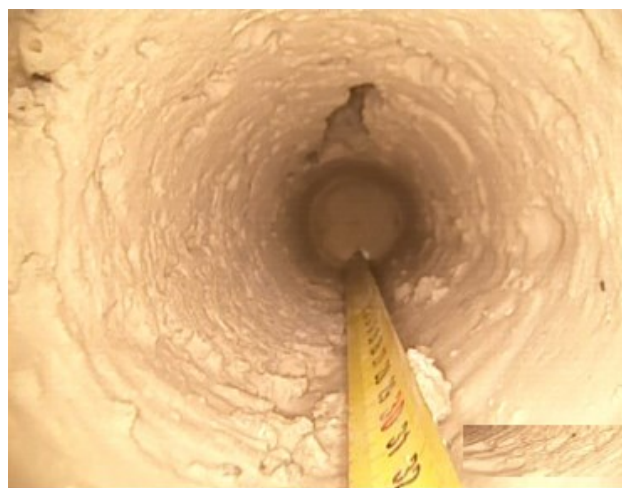
Figura 5.26 - Endoscopia svolta all'interno del quinto carotaggio
