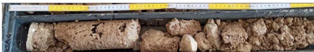
Figura 5.23 - Carota quarto test, paramento interno, lato est, primo livello. Lunghezza carota 73 cm.
