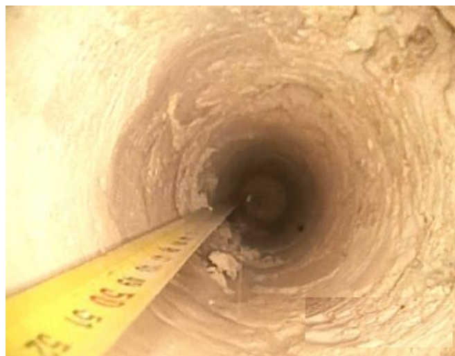
Figura 5.20 - Endoscopia svolta all'interno del secondo carotaggio
