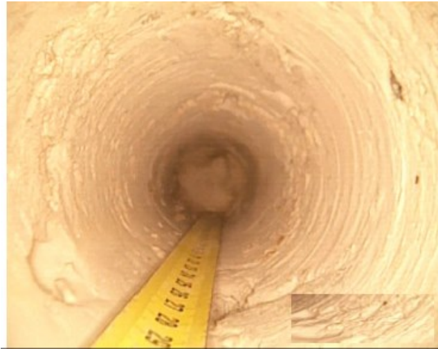
Figura 5.18 - Endoscopia svolta all'interno del primo carotaggio
