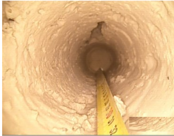
Figura 5.24 - Endoscopia svolta all'interno del quarto carotaggio
