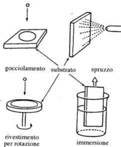
Fig. 1.10 – Metodi diversi per il ricoprimento del substrato nella tecnica sol-gel
