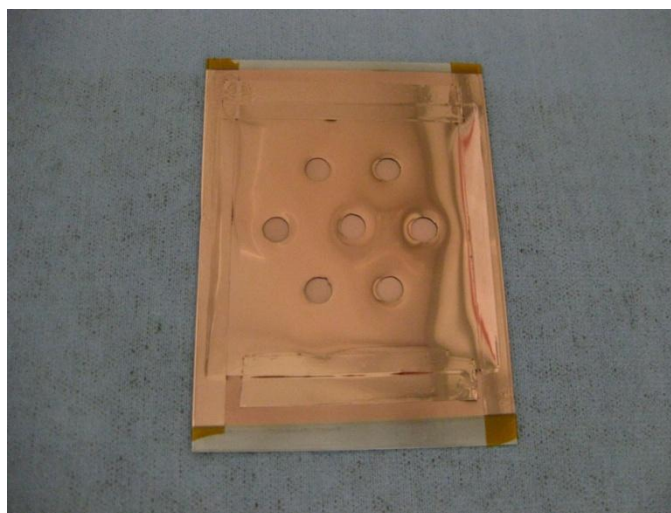
Fig. 5.3 – Deposito di rame realizzato sul substrato in kapton
