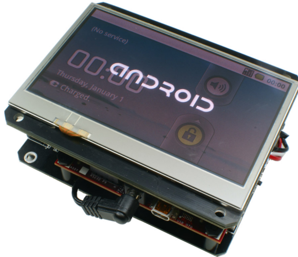
Figura 2: Un esempio di HMI privo dello chassis, con Android OS
