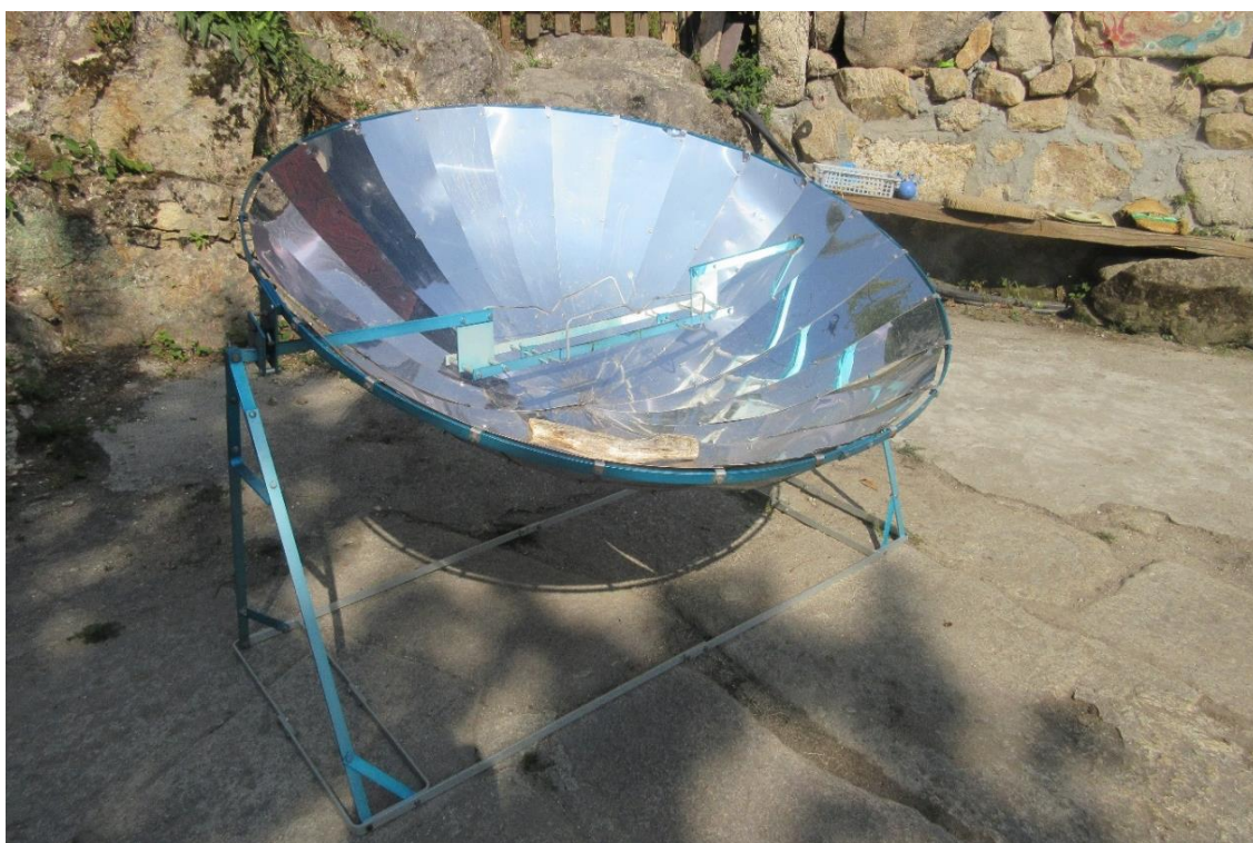
Figura 20. Cozinha solar da Ecoaldeia Vegetariana Espiral. Um concentrado parabólico direciona os raios solares num ponto focal [dia 4 de setembro de 2017, Sofia Zanotti].
