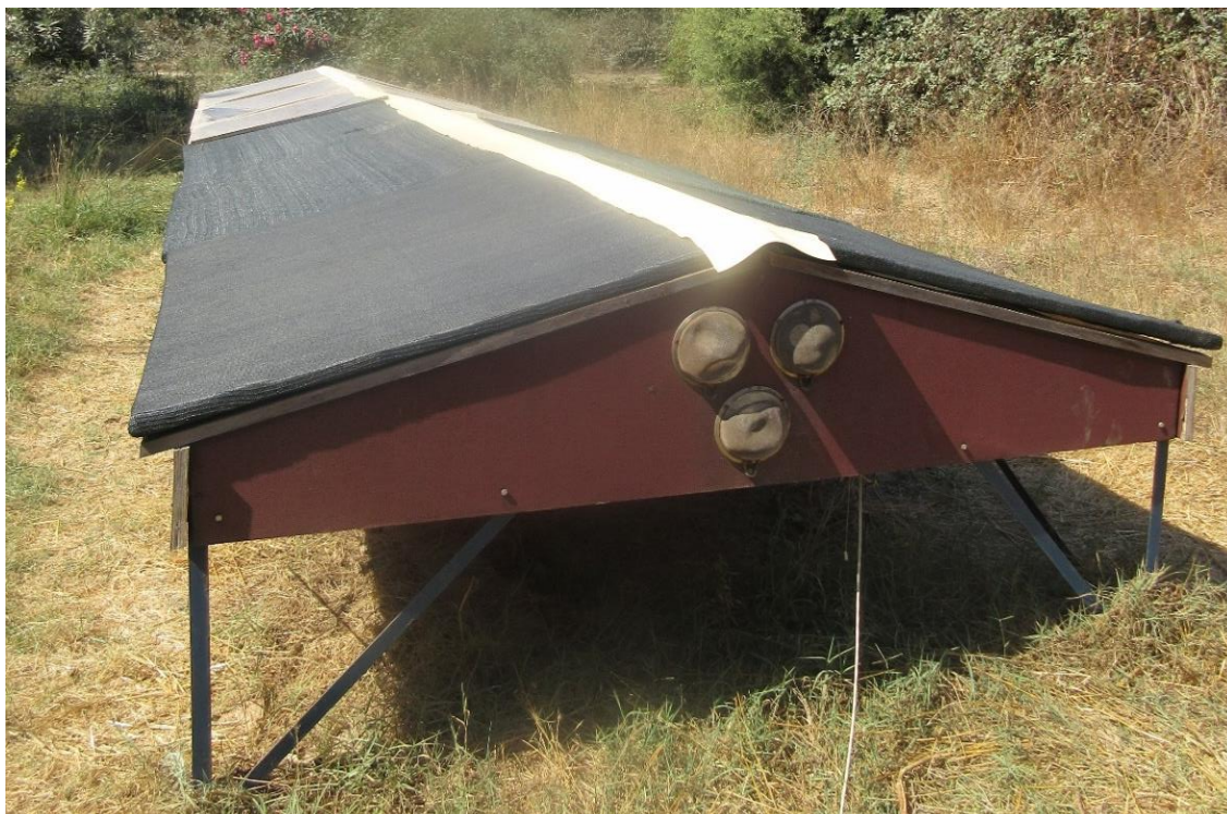
Figura 17. Túnel solar para a secagem de alimentos na Aldeia Solar de Tamera [dia 25 de agosto de 2017, Sofia Zanotti].
