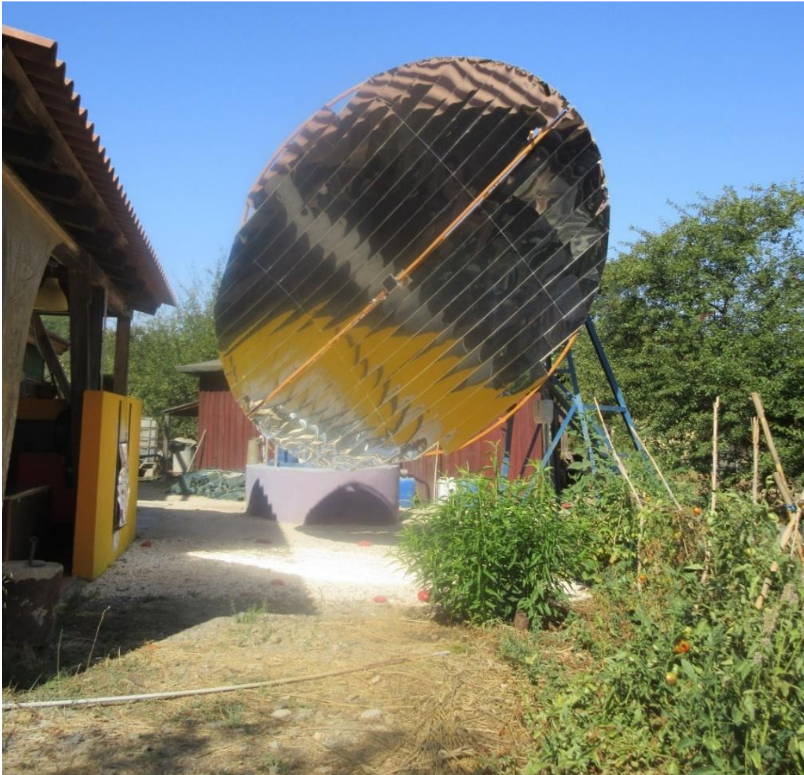
Figura 16. Espelho Scheffler da Aldeia Solar de Tamera. O espelho segue a rotação do sol focalizando os raios num ponto central da cozinha; com essa energia pode-se cozinhar durante todo o dia se estiver sol [dia 25 de agosto de 2017, Sofia Zanotti].
