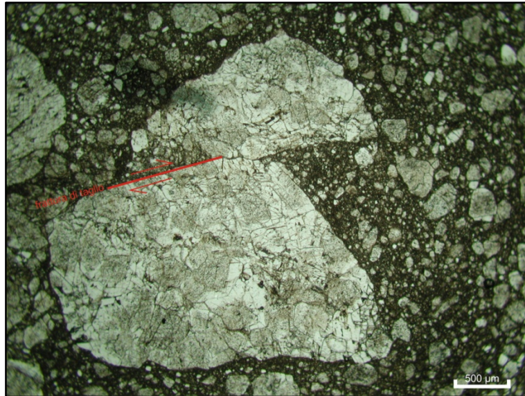
Fig. 3.11. Particolare di un clasto di dolomite zonata attraversato da una frattura di taglio (campione CIS11B, immagine OM, Nicols paralleli).
