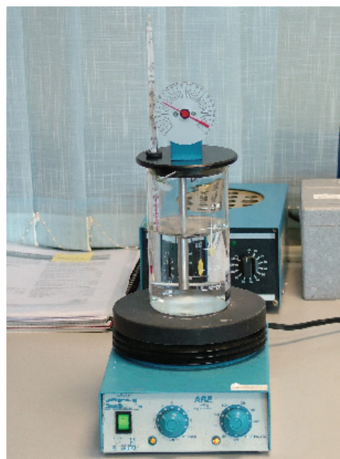
Figura 5.1. Strumento per la misurazione della temperatura di contrazione
