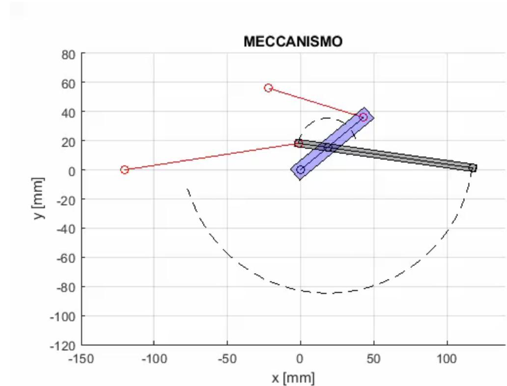
**Simulazione del salto: si ipotizza che M ed S finiscano la corsa contemporaneamente**
