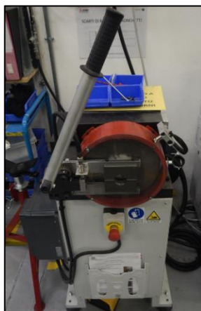
Figura 5.2: Tagliatubi orbitale elettrico (Fonte interna MEHITS)
