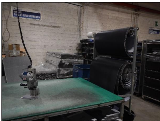
Figura 4.7: Banco di lavoro del reparto rivestimenti, con la bobina di isolante a sinistra e il cutter appoggiato sul banco (Fonte interna MEHITS)
