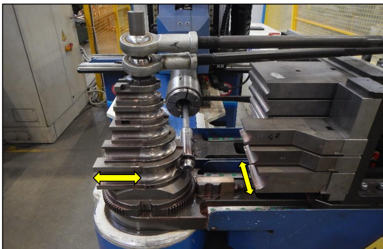
Figura 6.16: Morsa e matrice della macchina curvatubi, con rappresentazione della lunghezza del tratto minimo iniziale (Fonte interna MEHITS)
