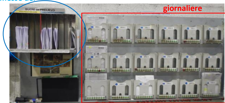
Figura 4.26: Tabellone del reparto PTB; a sinistra si può vedere la tasca suddivisa in giorni (Lunedì-Venerdì) in cui il gestore inserisce le commesse da lavorare, a destra il sequenziatore delle commesse giornaliere suddiviso per linea produttiva (Fonte interna MEHITS)
