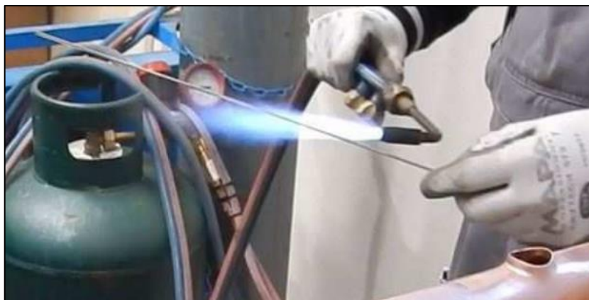
Figura 7.10: Riscaldamento del materiale d'apporto (bacchetta) mediante l'utilizzo del cannello (Fonte interna MEHITS)
