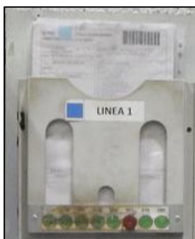
Figura 4.28: Tasca del sequenziatore. In basso si può vedere la riga su cui posizionare le calamite, in base al diametro dei tubi della commessa (Fonte interna MEHITS)
