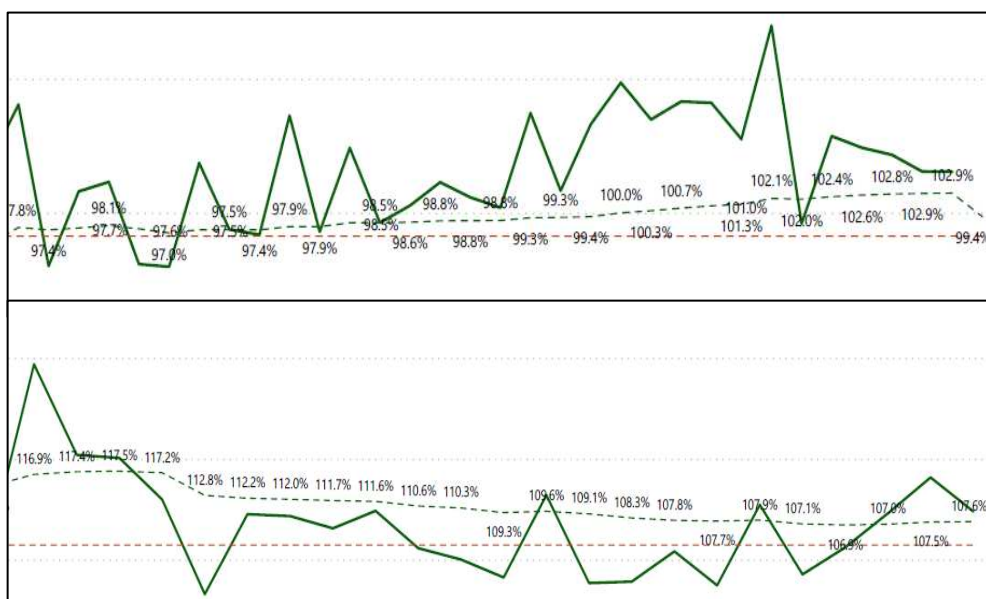
Figura 7.6: Trend del rendimento operativo delle unità NX-W/WN, prima dell'introduzione della finitura del tubo (sopra) e successivamente (sotto) (Fonte interna MEHITS)
