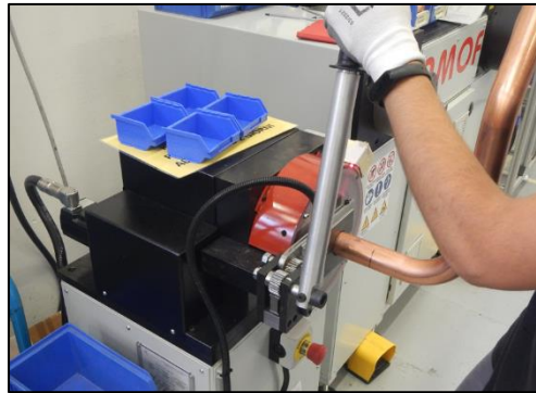
Figura 5.15: Taglio della tubazione in rame con tagliatubi orbitale (Fonte interna MEHITS)
