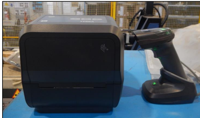
Figura 6.5: Stampante di etichette con lettore installata in reparto PTB (Fonte interna MEHITS)
