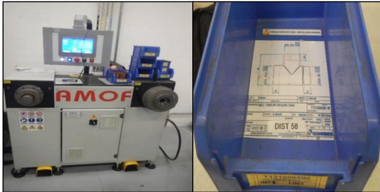
Figura 5.3: Macchina per espansioni/rastremature (sinistra) ed esempio di componente rastremato (destra) (Fonte interna MEHITS)
