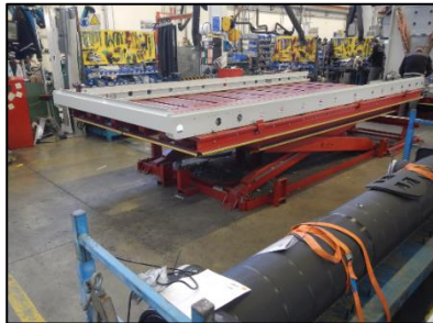
Figura 4.12: Posa dei longheroni nella fase ASB con evaporatore a fascio tubiero pronto per la posa (Fonte interna MEHITS)
