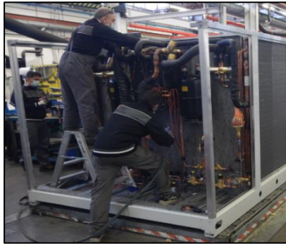
Figura 4.14: Due operatori impegnati nella realizzazione del circuito frigorifero (Fonte interna MEHITS)
