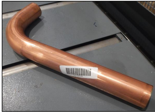
Figura 6.4: Tubazione in rame con applicazione della sua etichetta a codice a barre (Fonte interna MEHITS)
