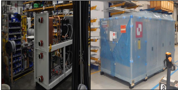
Figura 4.20: unità in fase di finitura in uscita dal collaudo (sinistra) ed unità imballata pronta ad essere spedita al cliente finale (Fonte interna MEHITS)
