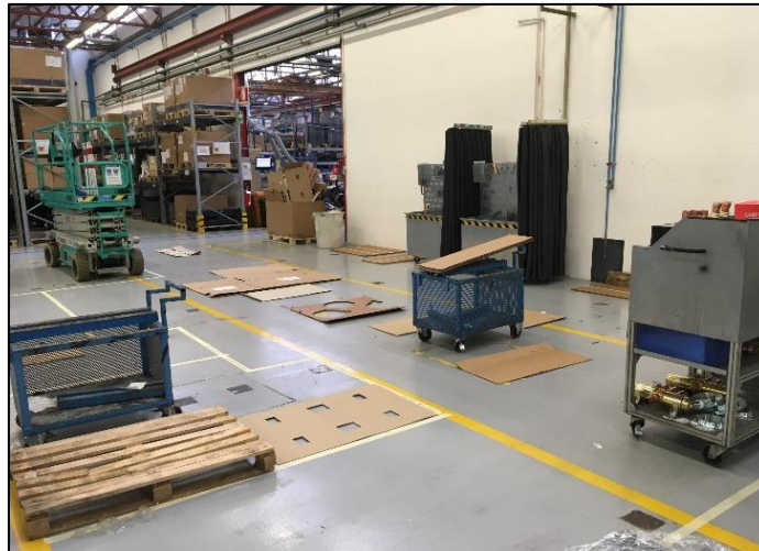
Figura 5.6: Valutazione degli ingombri delle attrezzature mediante l'applicazione di nastro carta nel nuovo reparto (Fonte interna MEHITS)
