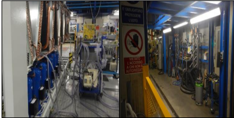
Figura 4.19: Messa in vuoto dell'unità (sinistra) e cabina di collaudo (destra) (Fonte interna MEHITS)
