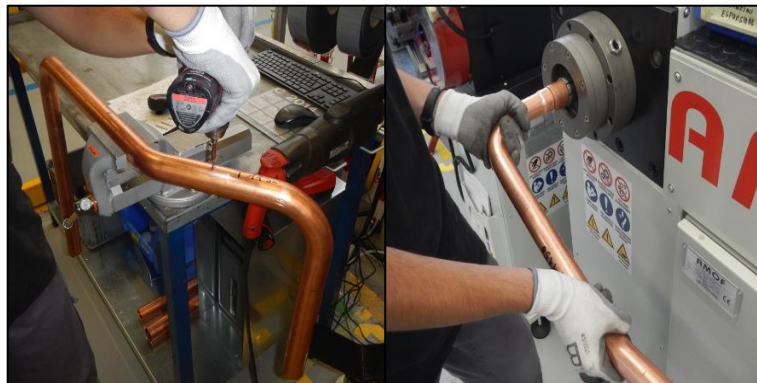
Figura 5.18: Foratura per prese di pressione (sinistra) ed espansione (destra) (Fonte interna MEHITS)
