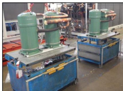
Figura 4.13: Postazione di pre-montaggio compressori ad opera finita, pronti ad essere installati in macchina (Fonte interna MEHITS)
