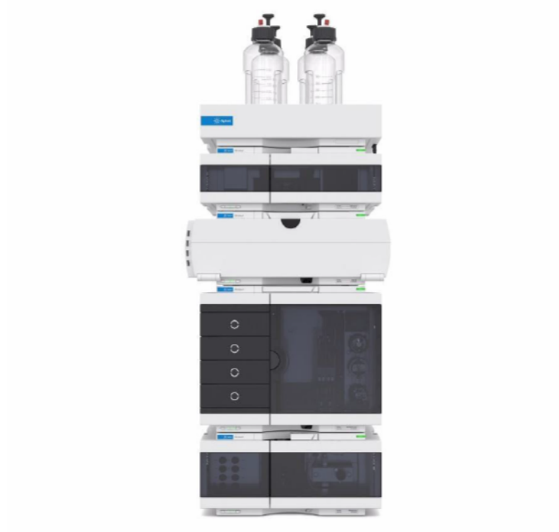
Figura 25. Strumento HPLC (cromatografo liquido ad alte prestazioni) 1260 Infinity II Agilent presente nel laboratorio di ricerca.
