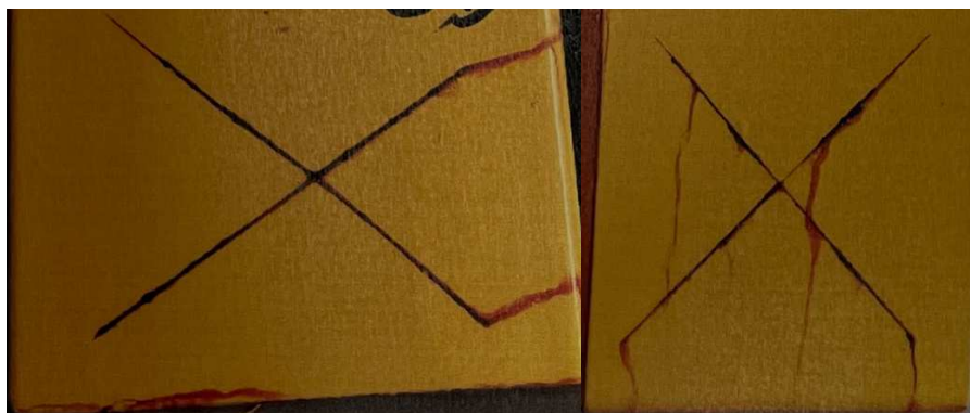
Fig 22: Foto della terza prova del campione zincato 3,4 dopo 640h di nebbia salina neutra
