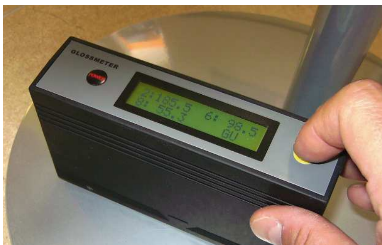
Fig 17: Misurazione brillantezza tramite glossmetro
