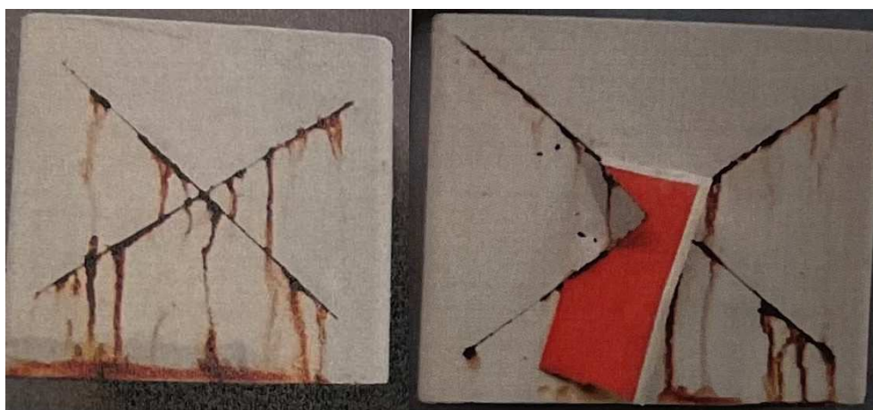
Fig 21: Foto della seconda prova del campione Ferro 5 dopo 560h e 640h di test di nebbia salina
