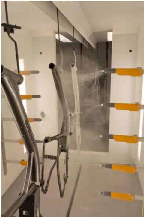
Fig 4: Cabina di verniciatura in funzione
