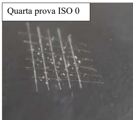
Fig 25: Immagini dei campioni delle quattro prove dopo il cross cutting test
