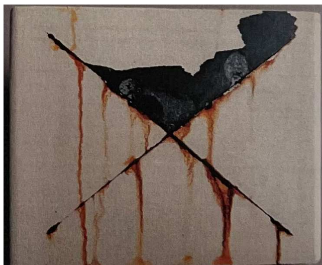
Fig 20: Foto della prima prova del campione Ferro 2 dopo 640h di test di nebbia salina
