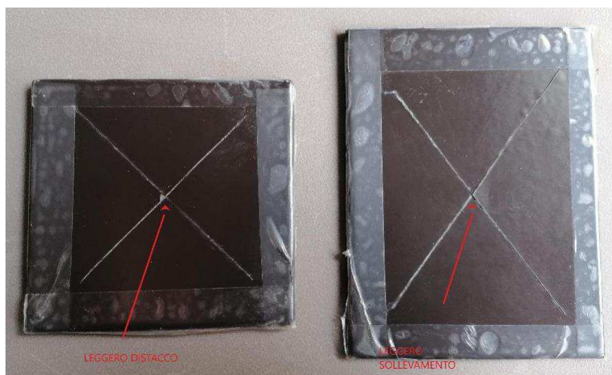
Fig 24: Foto del test 4 del campione ferro 4 dopo 720h di nebbia salina neutra
