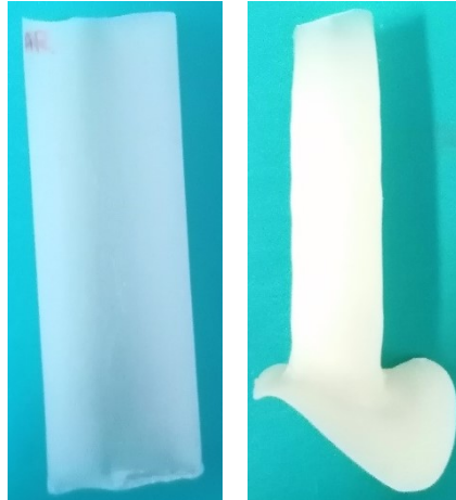
Figura 2.5 Condotti tubulari ottenuti con la tecnica della inversione di fase. A sinistra il condotto prodotto con Chronoflex AR; a destra quello prodotto in Chronoflex AR-LT.
