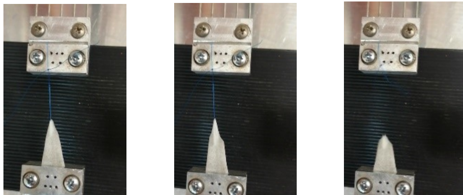
Figura 2.8 Passaggi del Suture retention strenght . A sinistra il provino a cui è stato applicato un punto di sutura fissato nella macchina. Al centro il campione sottoposto a trazione. A destra la rottura del campione
