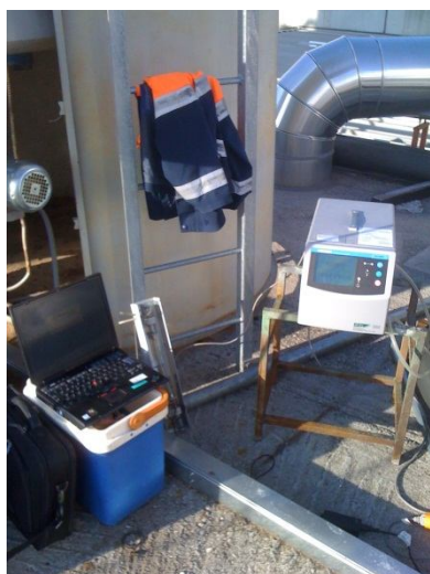
Figura 5.4 campionatori per analisi delle emissioni convogliate
