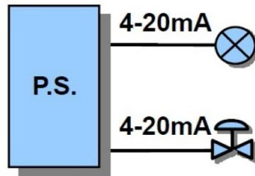
Fig. 2.1: Schematizzazione di un anello di corrente 4-20 mA
