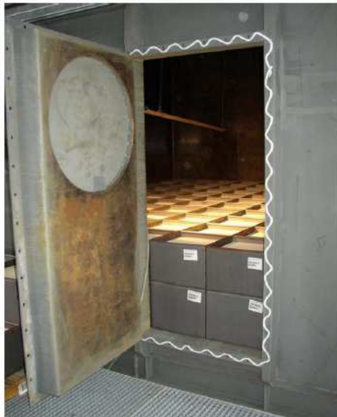
Figura 4.4 Disposizione del letto catalitico all'interno del reattore. Fonte Topsoe
