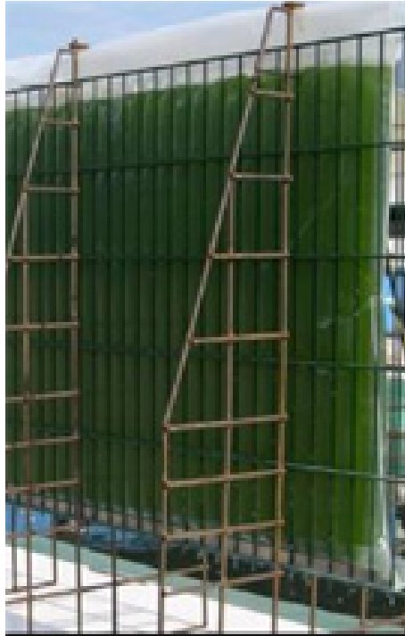
Figura 3.3 Modulo di fotobioreattore a sacca plastica (Green wall [3])
