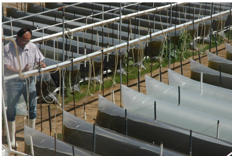
Figura 3.4 Batterie di fotobioreattori a sacca plastica [36]
