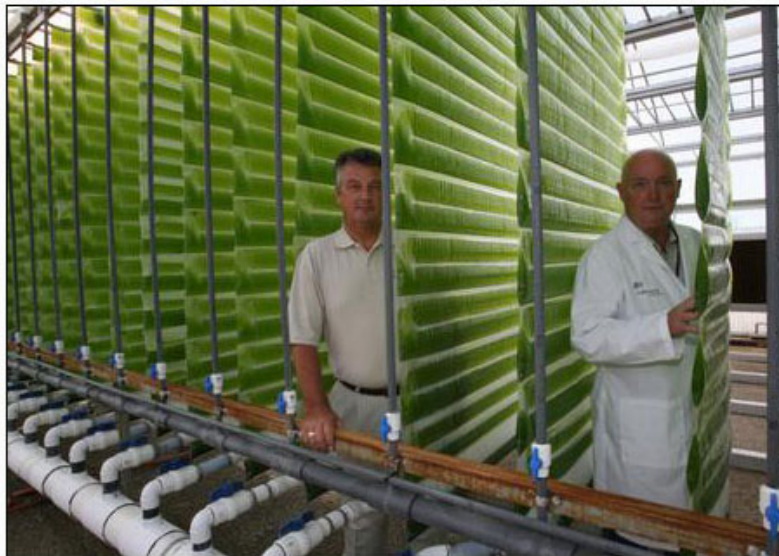
Figura 3.5 Arrays di fotobioreattori alveolari in membrana plastica [37]
