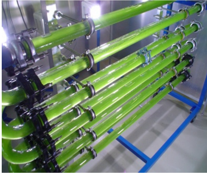
Figura 3.7 Esempio di reattore tubolare [26]
