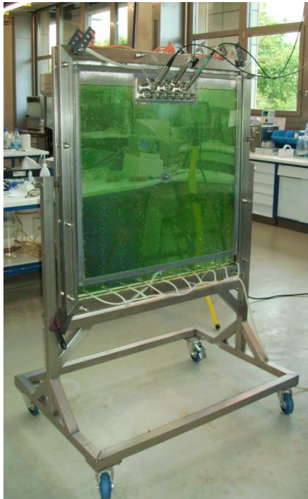
Figura 3.1 Prototipo da laboratorio di fotobioreattore a pannello [35]
