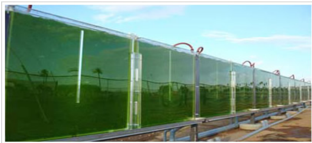
Figura 3.2 Array di fotobioreattori a pannello – impianto industriale [27]
