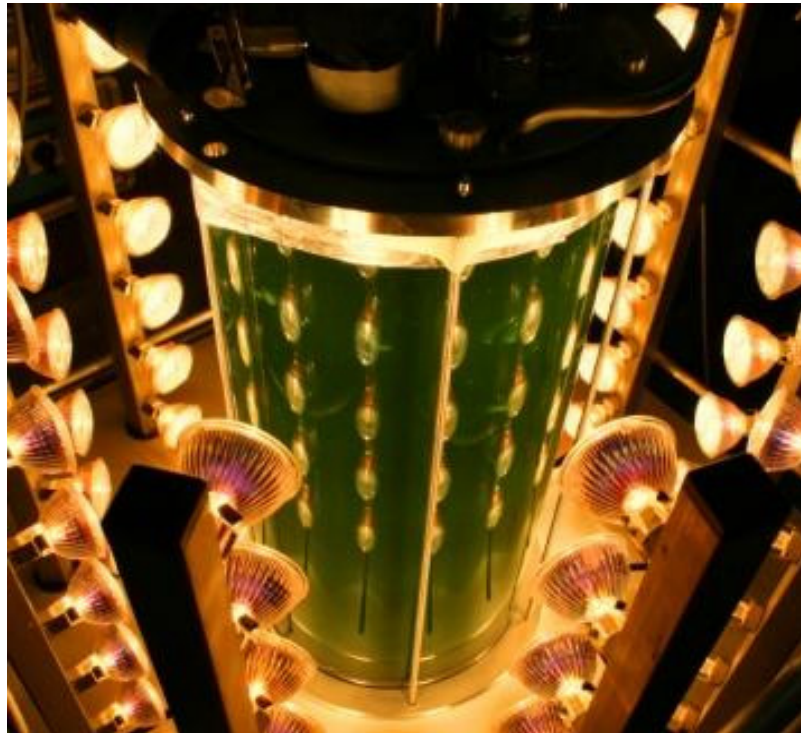
Figura 1.5 Fotobioreattore chiuso con illuminazione artificiale [28]
