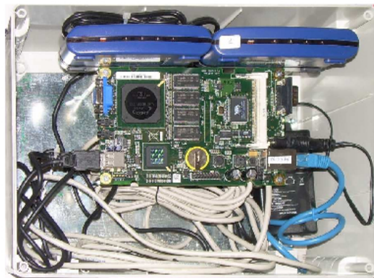
Figura 1.4: Un esempio di collegamento tra un Alix (NCG) e gli hub USB ai quali sono connessi i sensori
