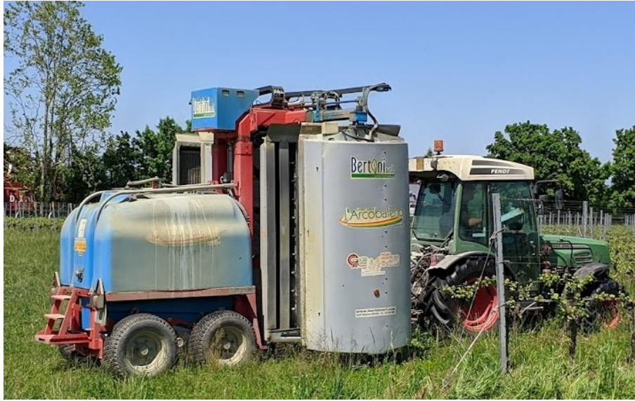
Figura 2.4 Irroratrice a tunnel a recupero Bertoni usata per la difesa chimica
