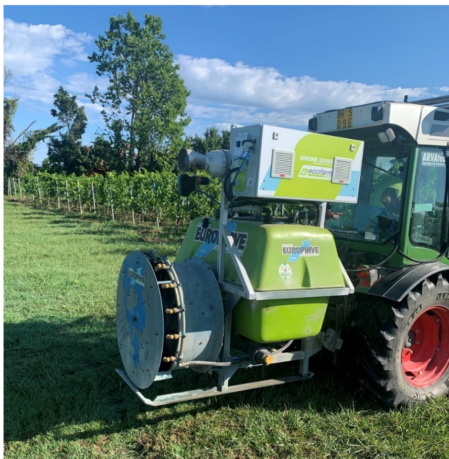
Figura 2.2 Irroratrice Europiave con generatore di ozono Ecofarm
